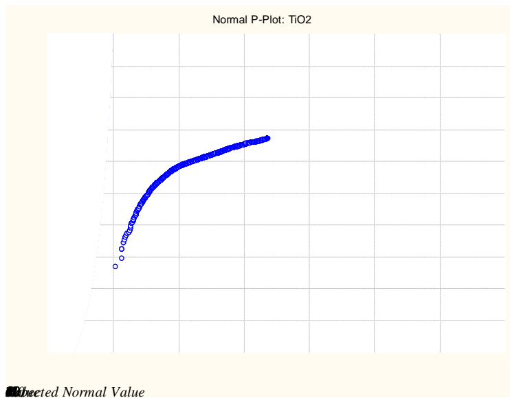
Figura VI.15. Teste lognormal para os dados de \text{TiO}_2 . O ajuste da curva linear da Figura VI.14 para uma curva logarítmica mostra que a distribuição dos dados de \text{TiO}_2 é lognormal.
