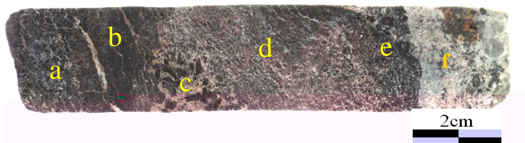
Figura II.38. Amostra 95sa é um testemunho de sondagem furo 95/96/37/38 comum na região sul do complexo. Em (a) foi realizada uma análise modal que permitiu sua classificação com um flogopita apatitito. Em (b) a análise modal revelou um foscorito. Em (c) um nelsonito, em (d) um apatita flogopitito metassomático e em (e) um flogopita apatitito. Na extrema direita (f) ocorre um dique de carbonatito magnésítico com monazita e pirita. Localização: Figura anexo 01.
