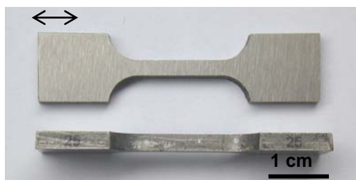
Figura 8. Corpo-de-prova finalizado para o ensaio mecânico de tração.
