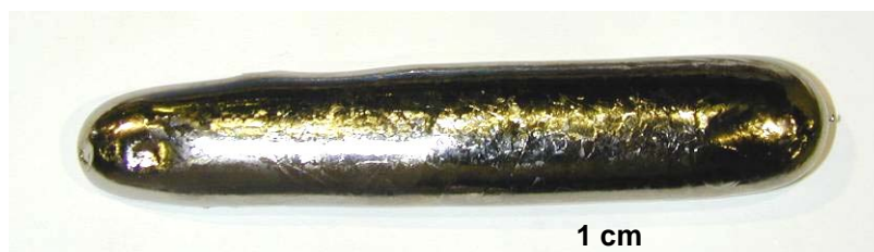
Figura 5. Lingote resultante da fusão a Arco.
