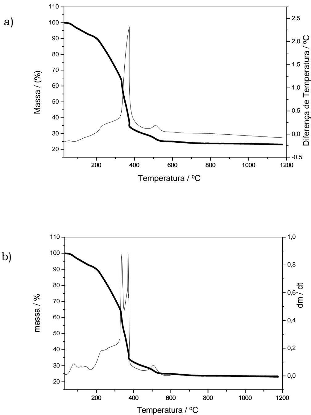
**Figura 30:** Curvas TG, DTA e DTG do 2-metoxibenzalpiruvato de Érbio, obtidos em atmosfera de ar sintético, fluxo de  $100 \text{ mL min}^{-1}$ , razão de aquecimento de  $20^\circ\text{C min}^{-1}$ , cadinho de Platina. a) Curvas TG-DTA; b) curvas TG/DTG.
