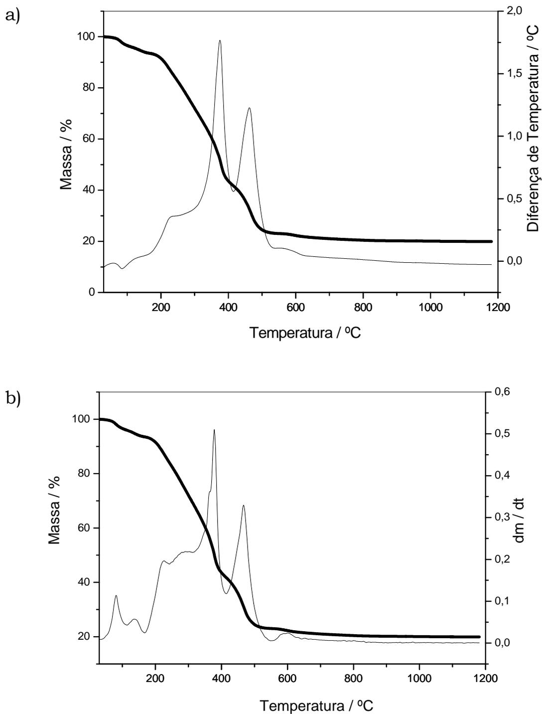
**Figura 36:** Curvas TG, DTA e DTG do 2-metoxibenzalpiruvato de Samário, obtidos em atmosfera de ar sintético, fluxo de  $100 \text{ mL min}^{-1}$ , razão de aquecimento de  $20^\circ\text{C min}^{-1}$ , cadinho de Platina. a) Curvas TG-DTA; b) curvas TG/DTG.
