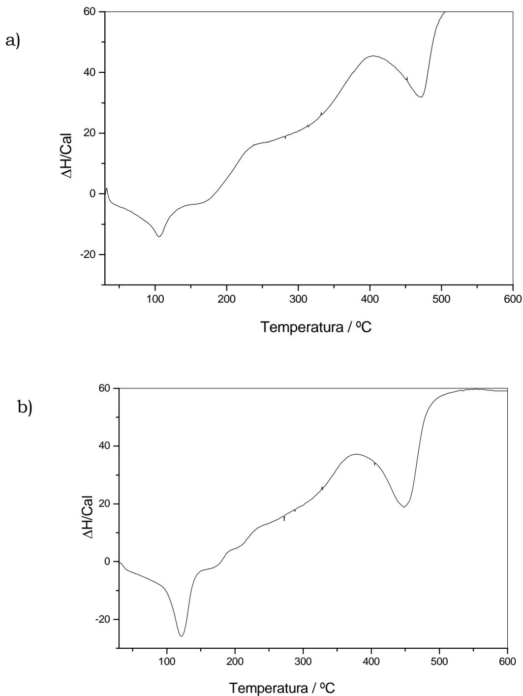
**Figura 44:** Curva DSC para os 2-metoxibenzalpiruvatos de a) Samário; b) Európio, obtidos em atmosfera de ar sintético, fluxo de  $100 \text{ mL min}^{-1}$ , razão de aquecimento de  $20 \text{ }^\circ\text{C min}^{-1}$ , cadinho de Alumínio.
