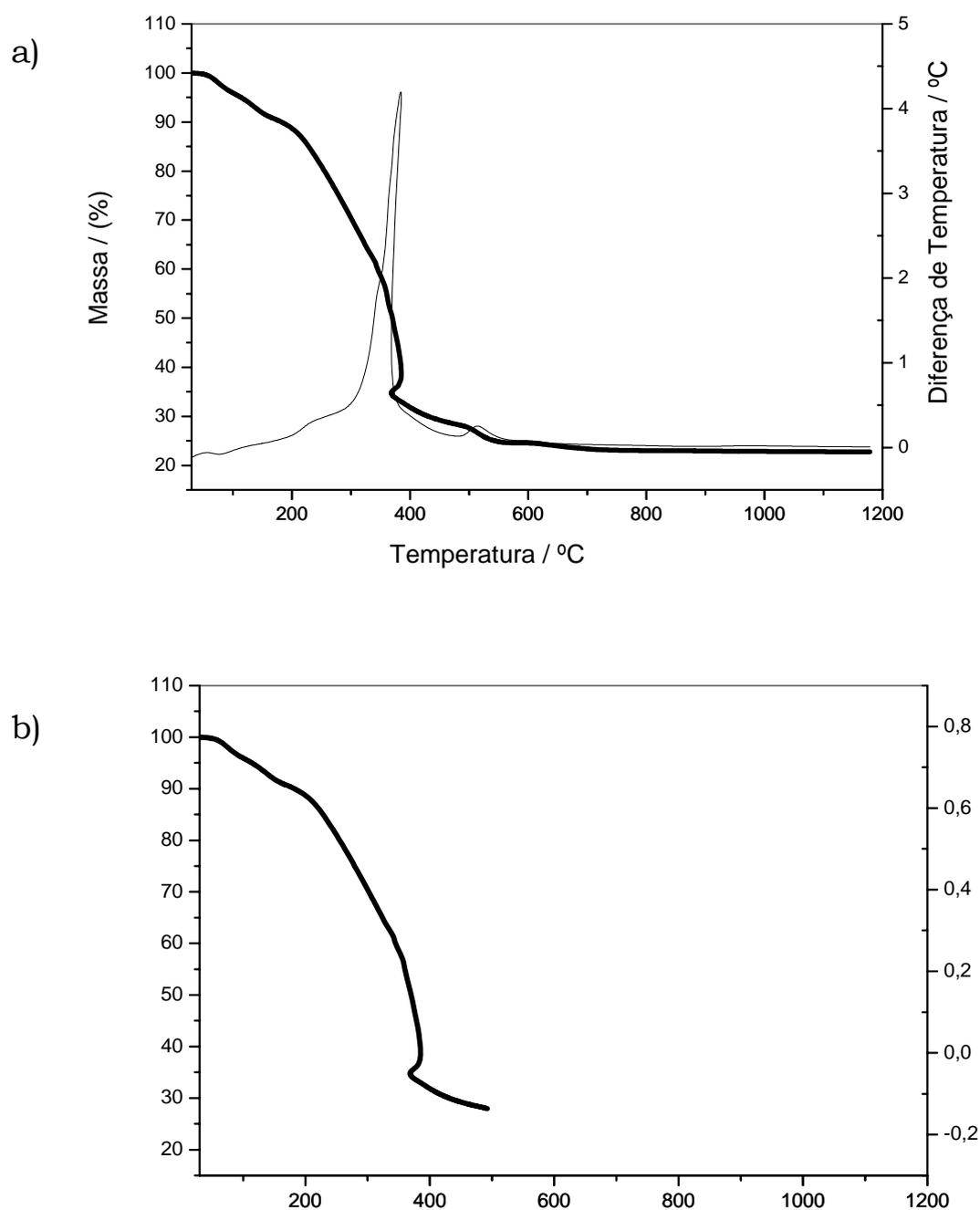
**Figura 39:** Curvas TG, DTA e DTG do 2-metoxibenzalpiruvato de Tulio, obtidos em atmosfera de ar sintético, fluxo de  $100 \text{ mL min}^{-1}$ , razão de aquecimento de  $20^\circ\text{C min}^{-1}$ , cadinho de Platina. a) Curvas TG-DTA; b) curvas TG/DTG.
