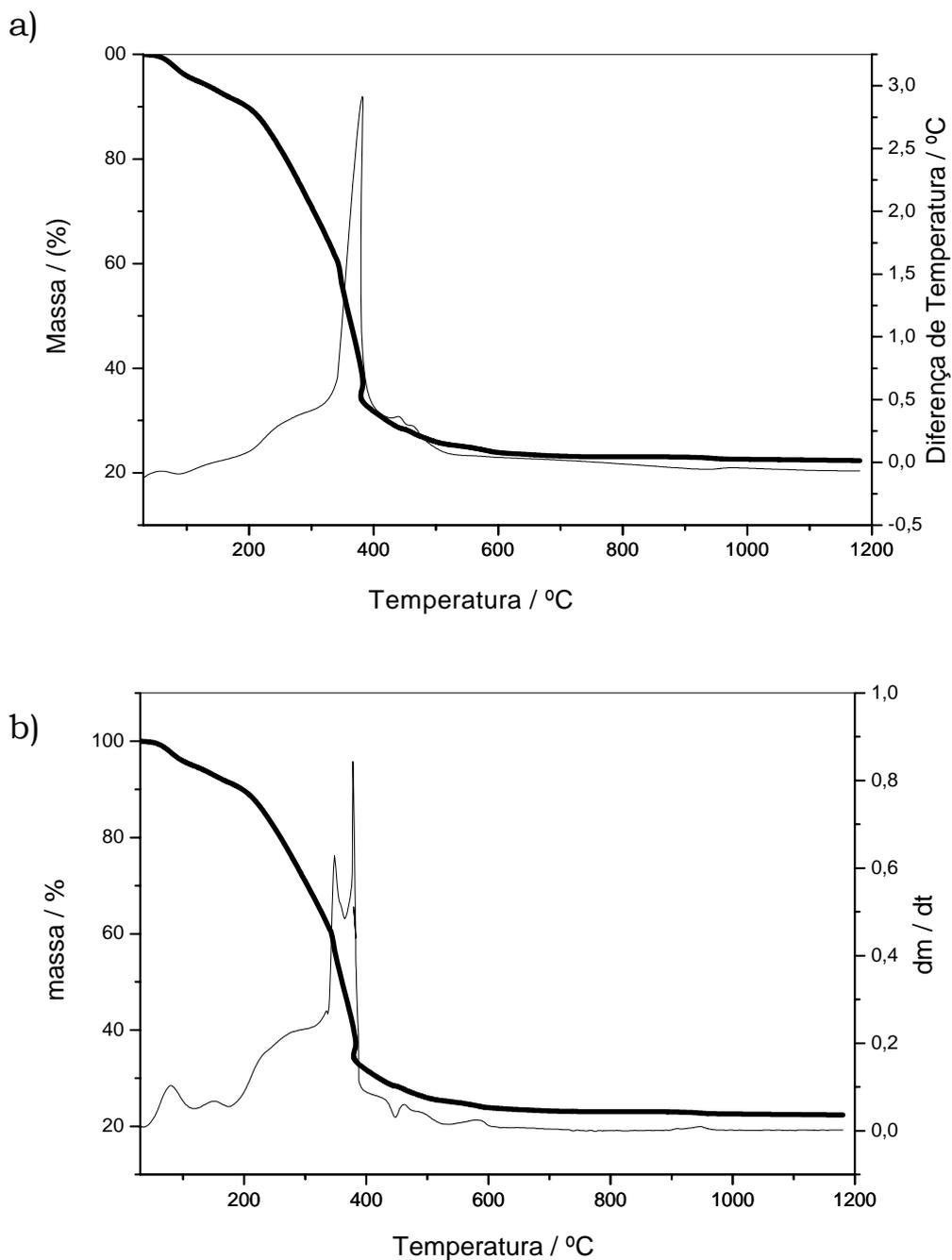
**Figura 37:** Curvas TG, DTA e DTG do 2-metoxibenzalpiruvato de Têrbio, obtidos em atmosfera de ar sintético, fluxo de  $100 \text{ mL min}^{-1}$ , razão de aquecimento de  $20^\circ\text{C min}^{-1}$ , cadinho de Platina. a) Curvas TG-DTA; b) curvas TG/DTG.
