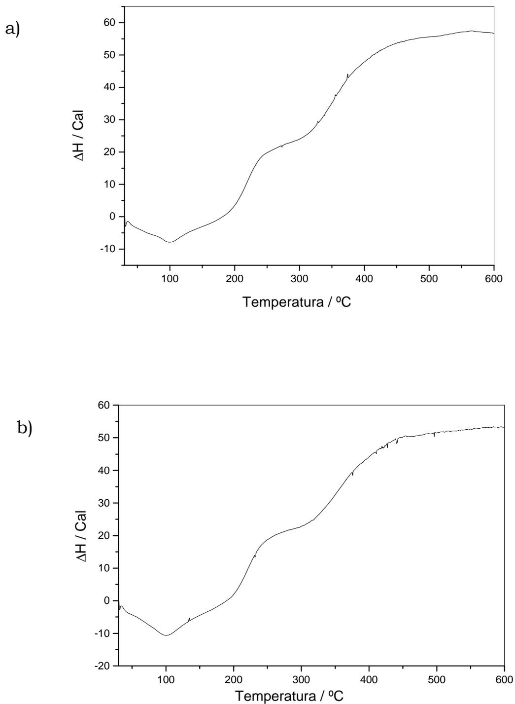
**Figura 45:** Curva DSC para os 2-metoxibenzalpiruvato de: a) Gadolinio; b) Têrbio; obtidos em atmosfera de ar sintético, fluxo de  $100 \text{ mL min}^{-1}$ , razão de aquecimento de  $20 \text{ }^\circ\text{C min}^{-1}$ , cadinho de Alumínio.
