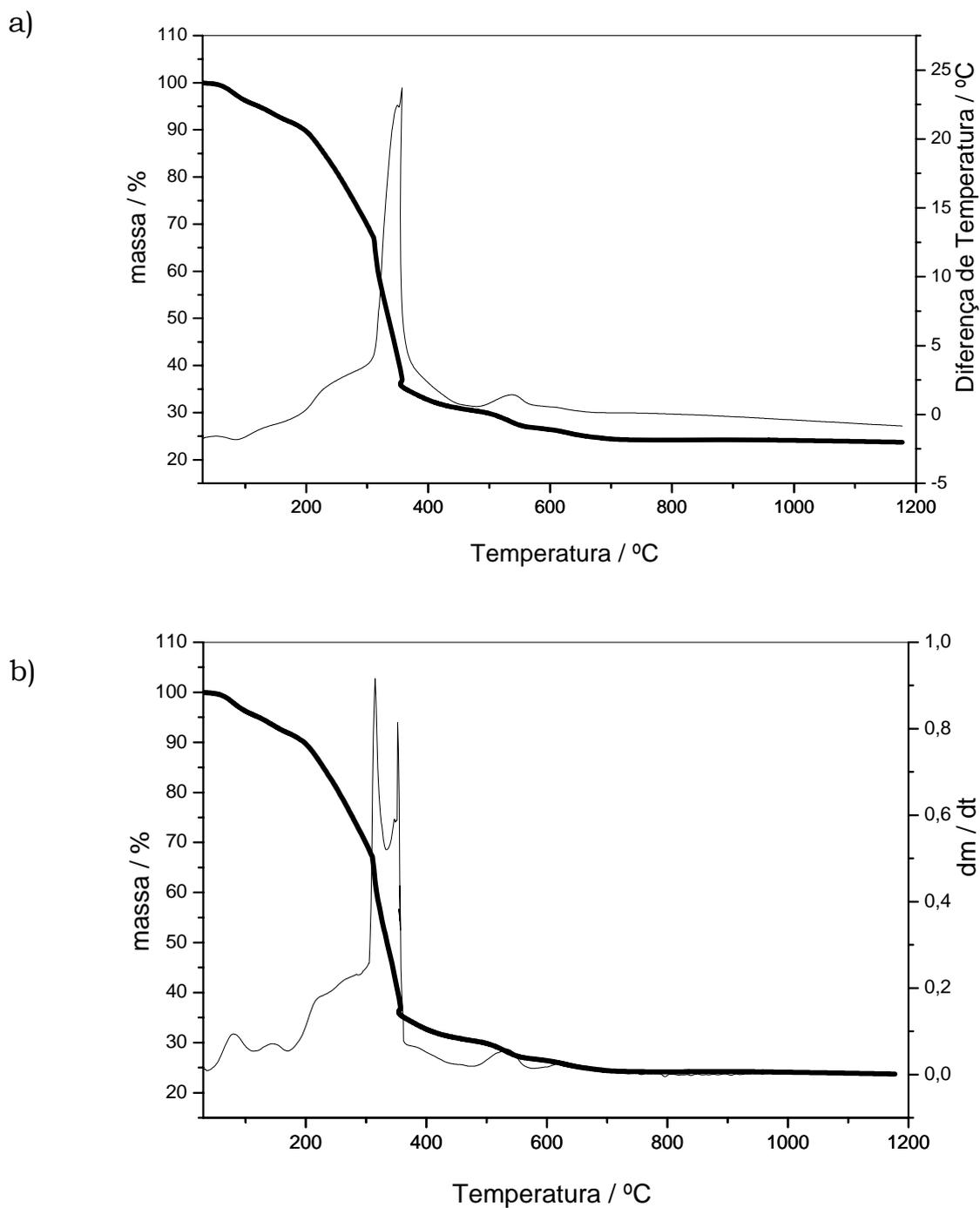
**Figura 28:** Curvas TG, DTA e DTG do 2-metoxibenzalpiruvato de Gadolínio, obtidos em atmosfera de ar sintético, fluxo de  $100 \text{ mL min}^{-1}$ , razão de aquecimento de  $20^\circ\text{C min}^{-1}$ , cadinho de Platina. a) Curvas TG-DTA; b) curvas TG/DTG.
