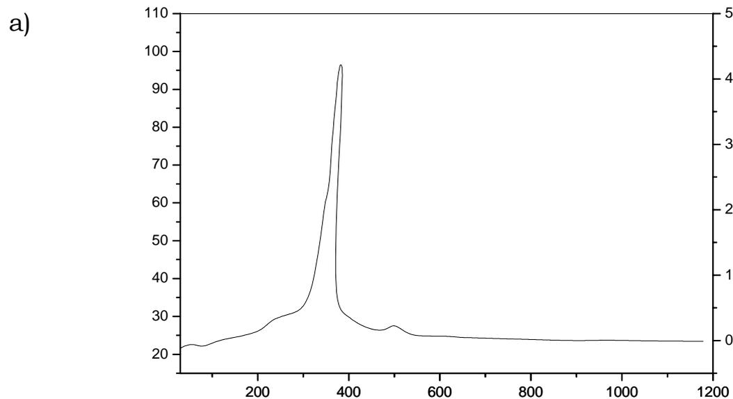
**Figura 40:** Curvas TG, DTA e DTG do 2-metoxibenzalpiruvato de Ytérbio, obtidos em atmosfera de ar sintético, fluxo de  $100 \text{ mL min}^{-1}$ , razão de aquecimento de  $20^\circ\text{C min}^{-1}$ , cadinho de Platina. a) Curvas TG-DTA; b) curvas TG/DTG.
