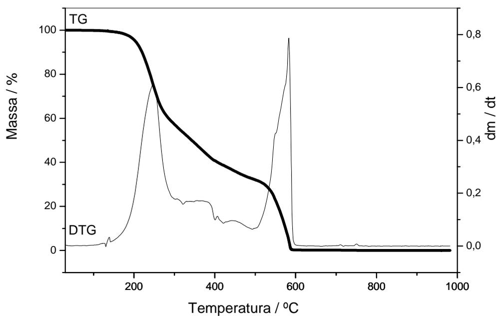
**Figura 24:** Curvas TG, DTA e DTG do ácido 2-metoxibenzalpirúvico, obtidos em atmosfera de ar sintético, fluxo de  $100 \text{ mL min}^{-1}$ , razão de aquecimento de  $20^\circ\text{C min}^{-1}$ , cadinho de Platina. a) Curvas TG-DTA; b) curvas TG/DTG.
