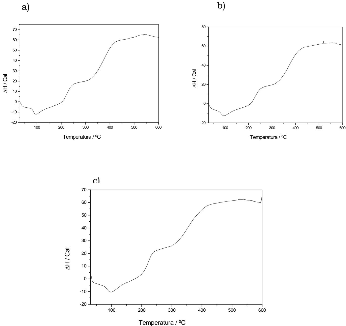
**Figura 48:** Curva DSC para os 2-metoxibenzalpiruvato de: a) Yterbio; b) Lutécio e c) Itrio; obtidos em atmosfera de ar sintético, fluxo de 100 mL  $\text{min}^{-1}$ , razão de aquecimento de 20  $^{\circ}\text{C min}^{-1}$ , cadinho de Alumínio.
