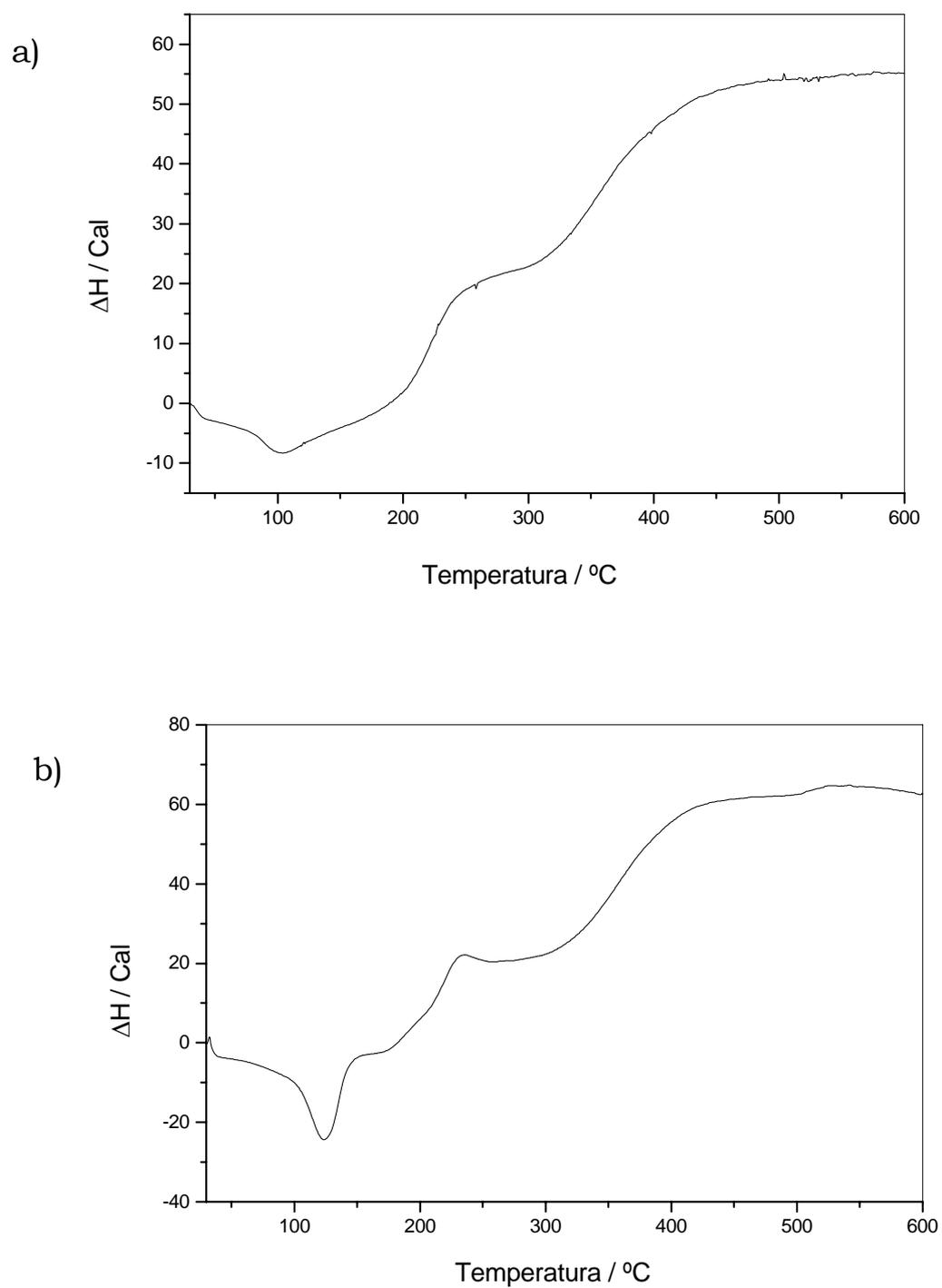
**Figura 46:** Curva DSC para os 2-metoxibenzalpiruvato de: a) Disprósio; b) Homio; obtidos em atmosfera de ar sintético, fluxo de  $100 \text{ mL min}^{-1}$ , razão de aquecimento de  $20 \text{ }^\circ\text{C min}^{-1}$ , cadinho de Alumínio.
