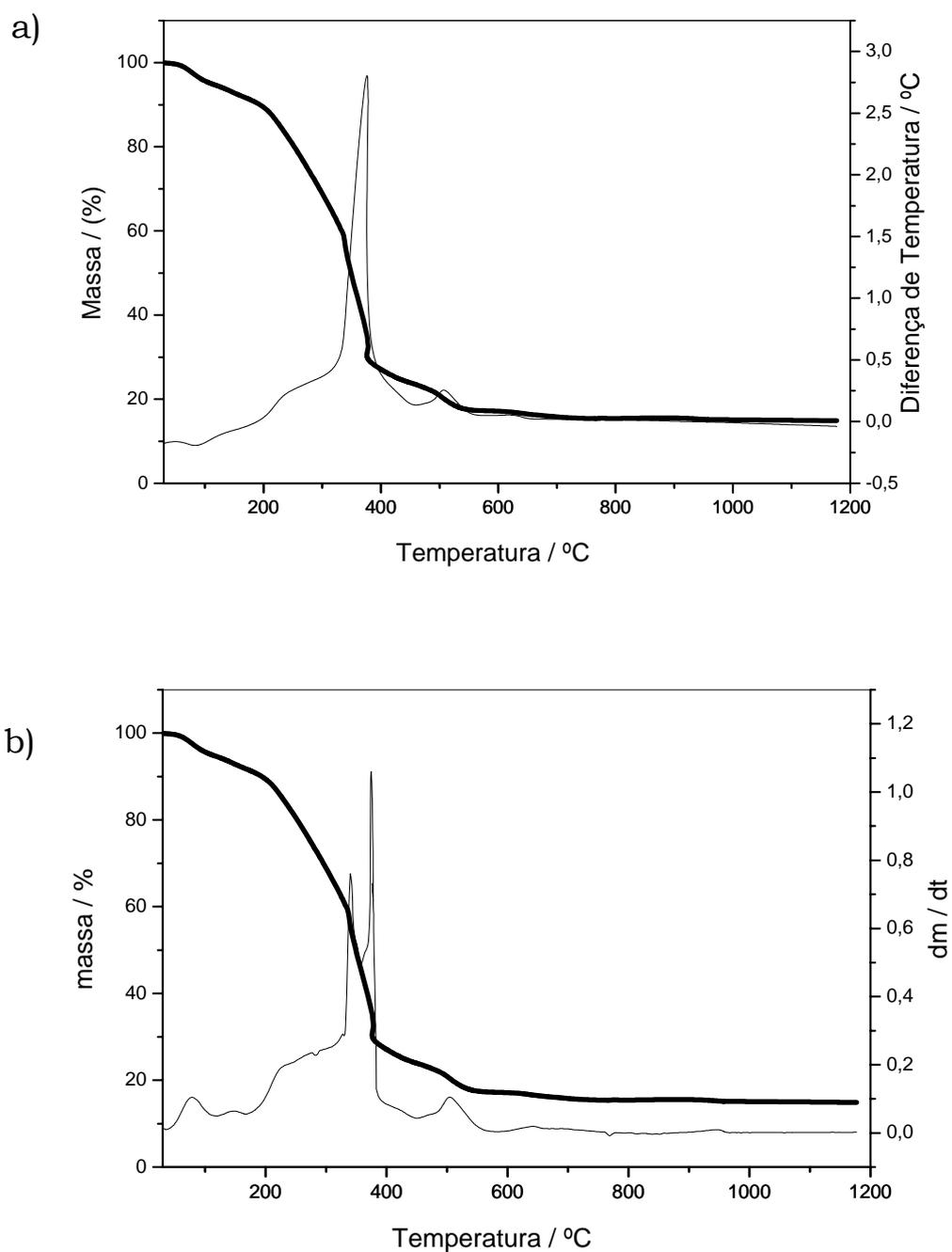
**Figura 31:** Curvas TG, DTA e DTG do 2-metoxibenzalpiruvato de Ytrio, obtidos em atmosfera de ar sintético, fluxo de 100 mL min<sup>-1</sup>, razão de aquecimento de 20°C min<sup>-1</sup>, cadinho de Platina. a) Curvas TG-DTA; b) curvas TG/DTG.
