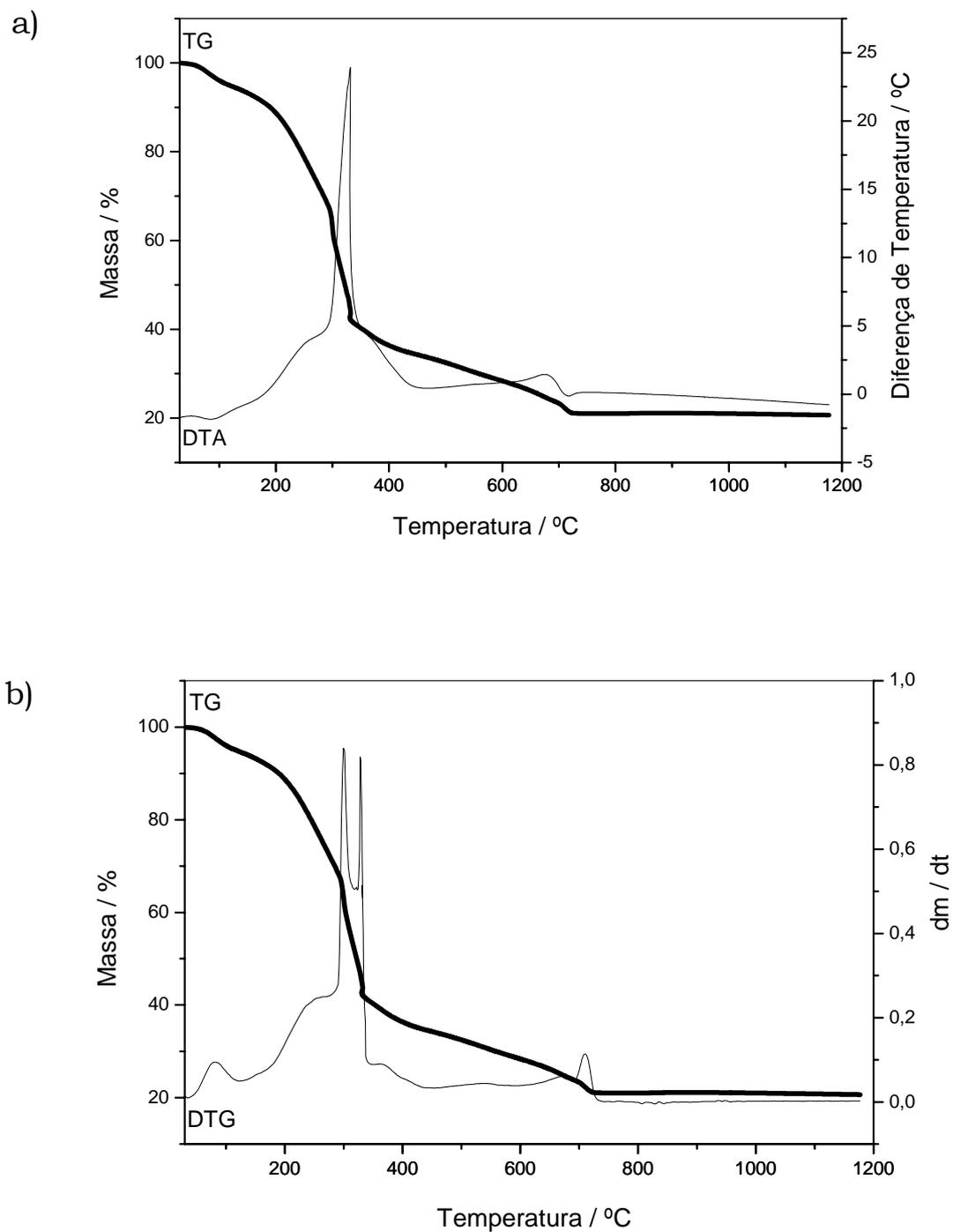
**Figura 27:** Curvas TG, DTA e DTG do 2-metoxibenzalpiruvato de lantânio, obtidos em atmosfera de ar sintético, fluxo de  $100 \text{ mL min}^{-1}$ , razão de aquecimento de  $20^\circ\text{C min}^{-1}$ , cadinho de Platina. a) Curvas TG-DTA; b) curvas TG/DTG.
