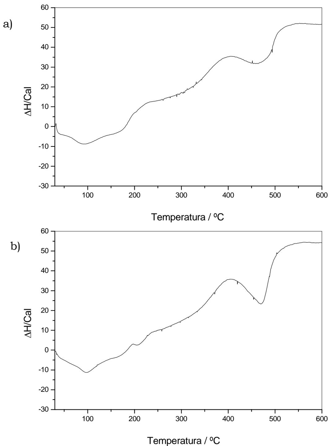
**Figura 43:** Curva DSC para os 2-metoxibenzalpiruvatos de: a) Praseodímio; b) Neodímio; obtidos em atmosfera de ar sintético, fluxo de  $100 \text{ mL min}^{-1}$ , razão de aquecimento de  $20 \text{ }^{\circ}\text{C min}^{-1}$ , cadinho de Alumínio.
