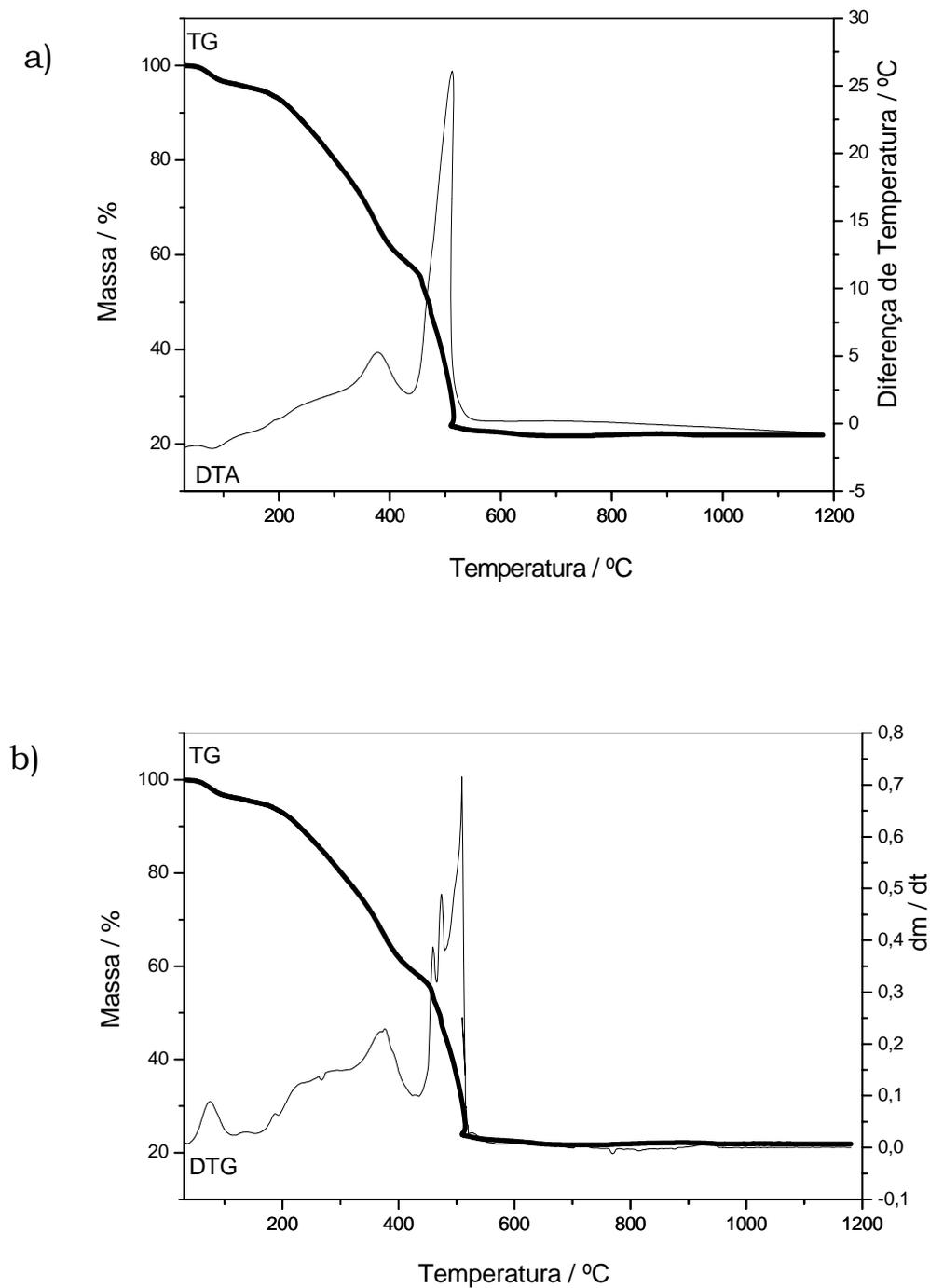
**Figura 34:** Curvas TG, DTA e DTG do 2-metoxibenzalpiruvato de Neodímio, obtidos em atmosfera de ar sintético, fluxo de  $100 \text{ mL min}^{-1}$ , razão de aquecimento de  $20^\circ\text{C min}^{-1}$ , cadinho de Platina. a) Curvas TG-DTA; b) curvas TG/DTG.
