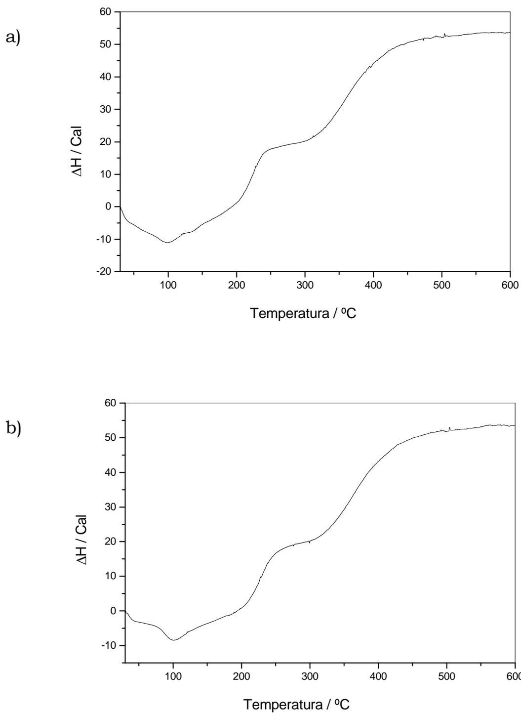
**Figura 47:** Curva DSC para os 2-metoxibenzalpiruvato de: a) Erbío; b) Túlio; obtidos em atmosfera de ar sintético, fluxo de 100 mL min<sup>-1</sup>, razão de aquecimento de 20 °C min<sup>-1</sup>, cadinho de Alumínio.
