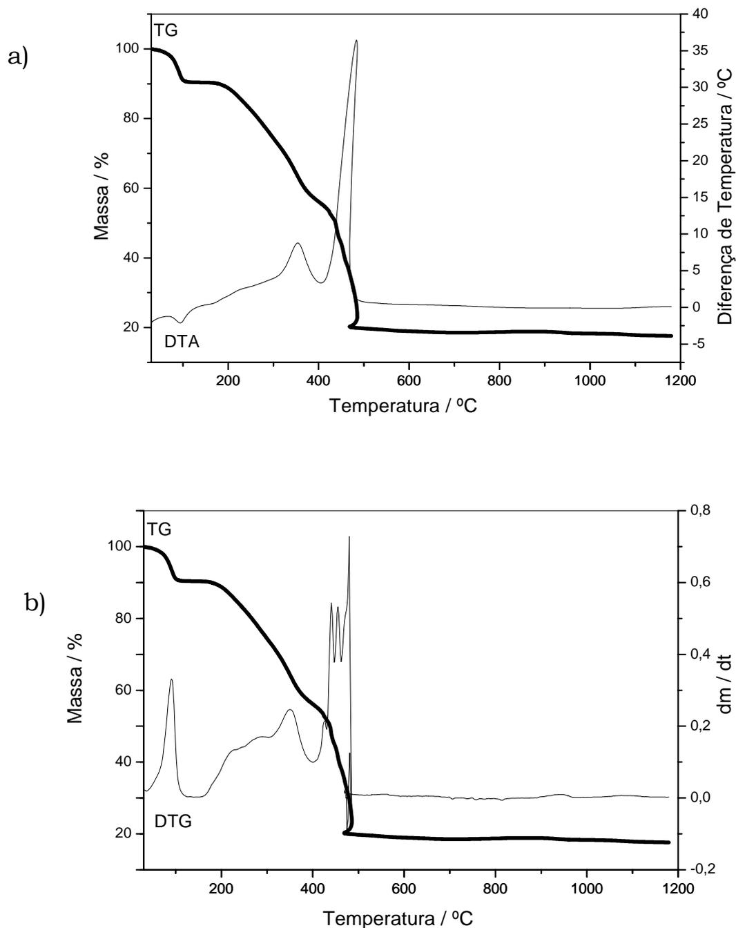
**Figura 35:** Curvas TG, DTA e DTG do 2-metoxibenzalpiruvato de Európio, obtidos em atmosfera de ar sintético, fluxo de  $100 \text{ mL min}^{-1}$ , razão de aquecimento de  $20^\circ\text{C min}^{-1}$ , cadinho de Platina. a) Curvas TG-DTA; b) curvas TG/DTG.
