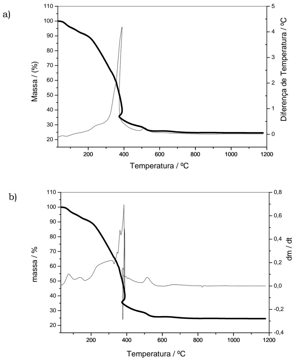
**Figura 41:** Curvas TG, DTA e DTG do 2-metoxibenzalpiruvato de Lutecio, obtidos em atmosfera de ar sintético, fluxo de  $100 \text{ mL min}^{-1}$ , razão de aquecimento de  $20^\circ\text{C min}^{-1}$ , cadinho de Platina. a) Curvas TG-DTA; b) curvas TG/DTG.
