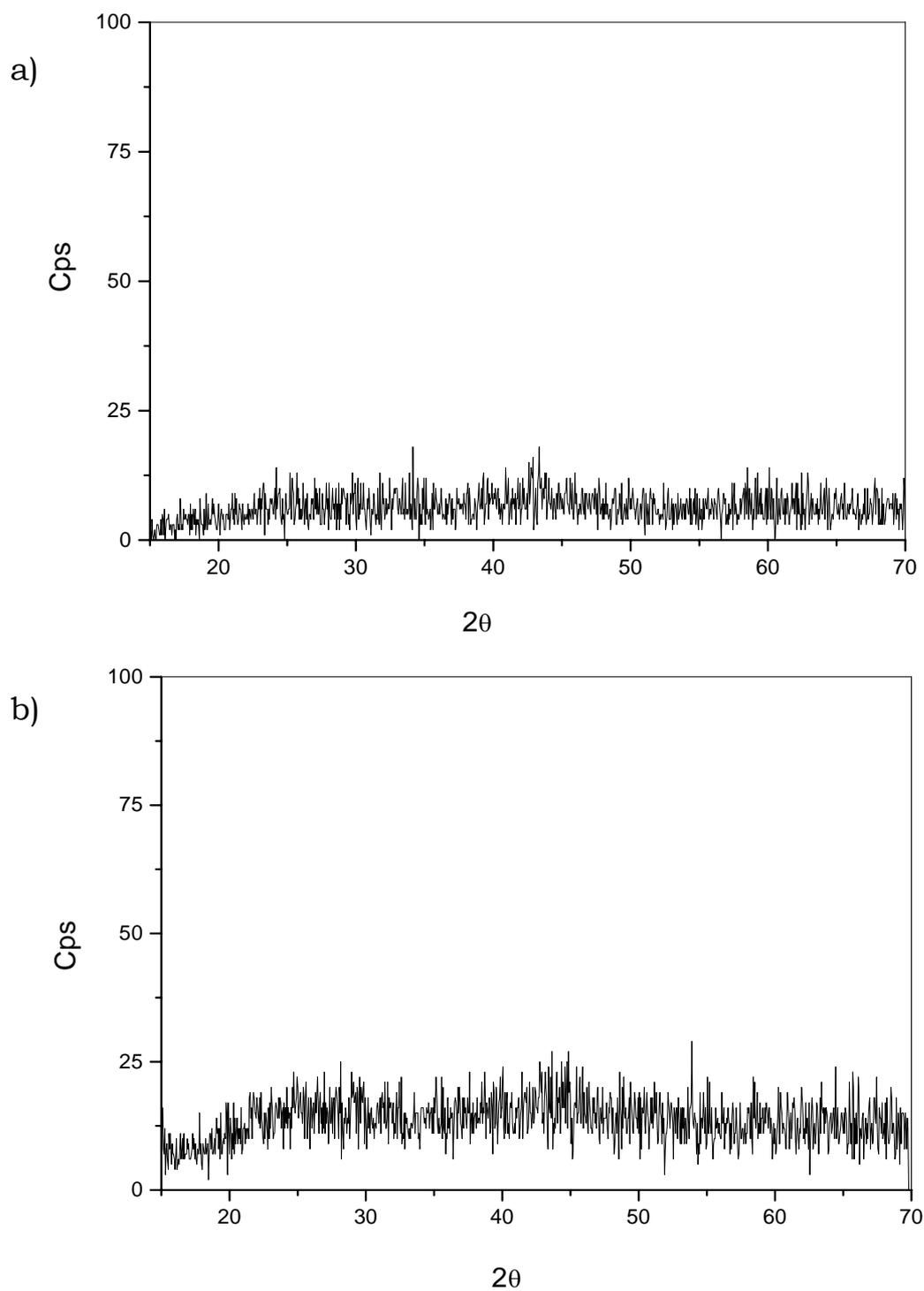
**Figura 51:** Difratoogramas de raios X para Os 2-metoxibenzalpiruvatos de: a) Holmio b) Lutécio. Utilizando fonte de radiação Cu  $K\alpha$  de  $\lambda = 1,78897 \times 10^{-1}$  nm, com exposição até  $70^\circ$  ( $2\theta$ ).
