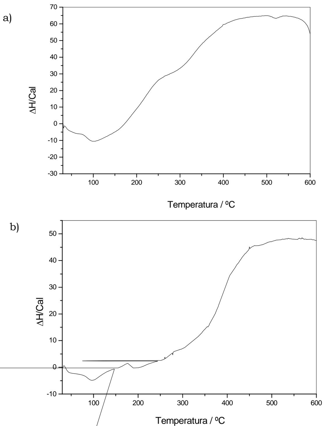
**Figura 42:** Curva DSC para os 2-metoxibenzalpiruvato de: a) Lantânio; b) Cério; obtidos em atmosfera de ar sintético, fluxo de 100 mL min<sup>-1</sup>, razão de aquecimento de 20 °C min<sup>-1</sup>, cadinho de Alumínio.
