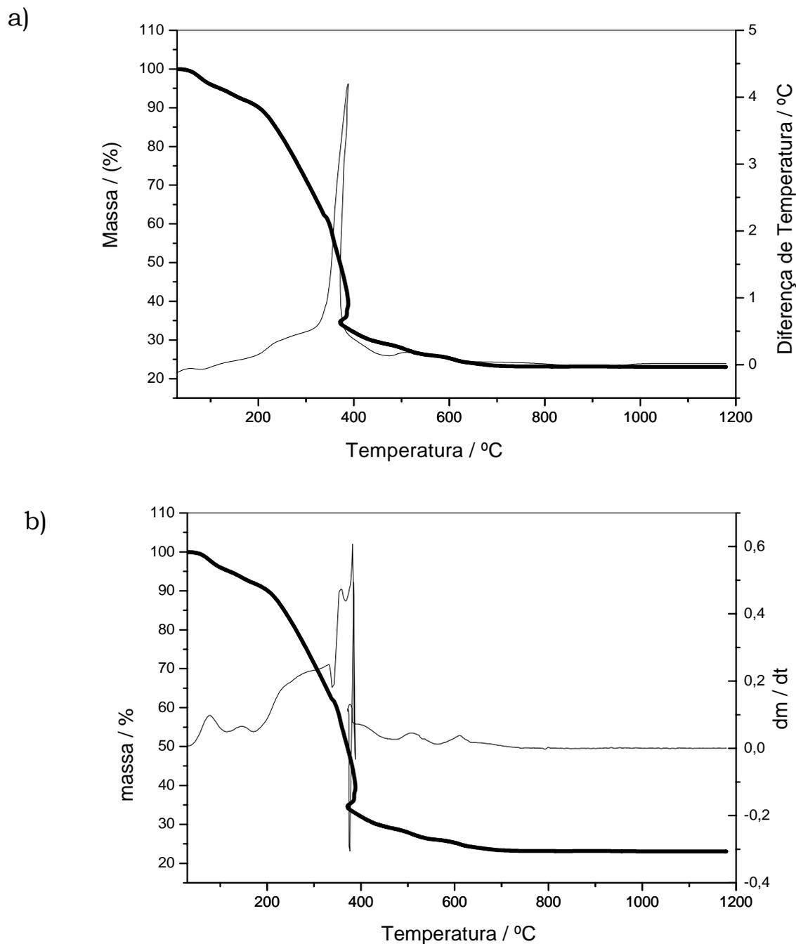
**Figura 38:** Curvas TG, DTA e DTG do 2-metoxibenzalpiruvato de Dysprósio, obtidos em atmosfera de ar sintético, fluxo de  $100 \text{ mL min}^{-1}$ , razão de aquecimento de  $20^\circ\text{C min}^{-1}$ , cadinho de Platina. a) Curvas TG-DTA; b) curvas TG/DTG.
