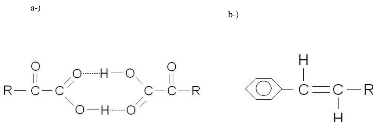
**Figura 21:** Estiramentos dos espectros na região do infravermelho do ácido 2-metoxibenzalpirúvico: a) vibração em  $3556\text{ cm}^{-1}$ , deformação axial do grupo OH do dímero formado. b) vibração em  $3309$ , deformação axial do H do grupo pirúvico.
