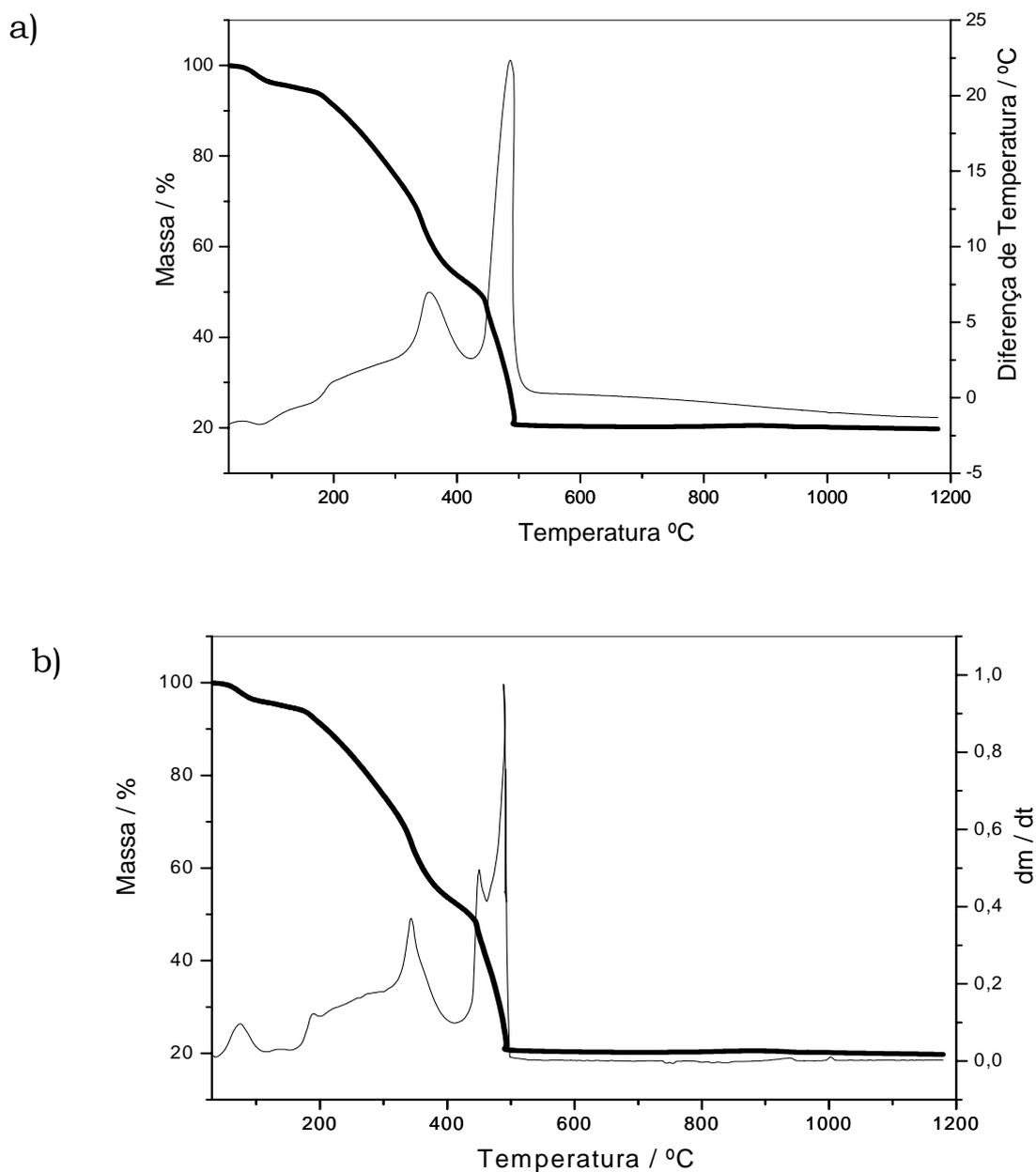
**Figura 33:** Curvas TG, DTA e DTG do 2-metoxibenzalpiruvato de Praseodímio, obtidos em atmosfera de ar sintético, fluxo de  $100 \text{ mL min}^{-1}$ , razão de aquecimento de  $20^\circ\text{C min}^{-1}$ , cadinho de Platina. a) Curvas TG-DTA; b) curvas TG/DTG.
