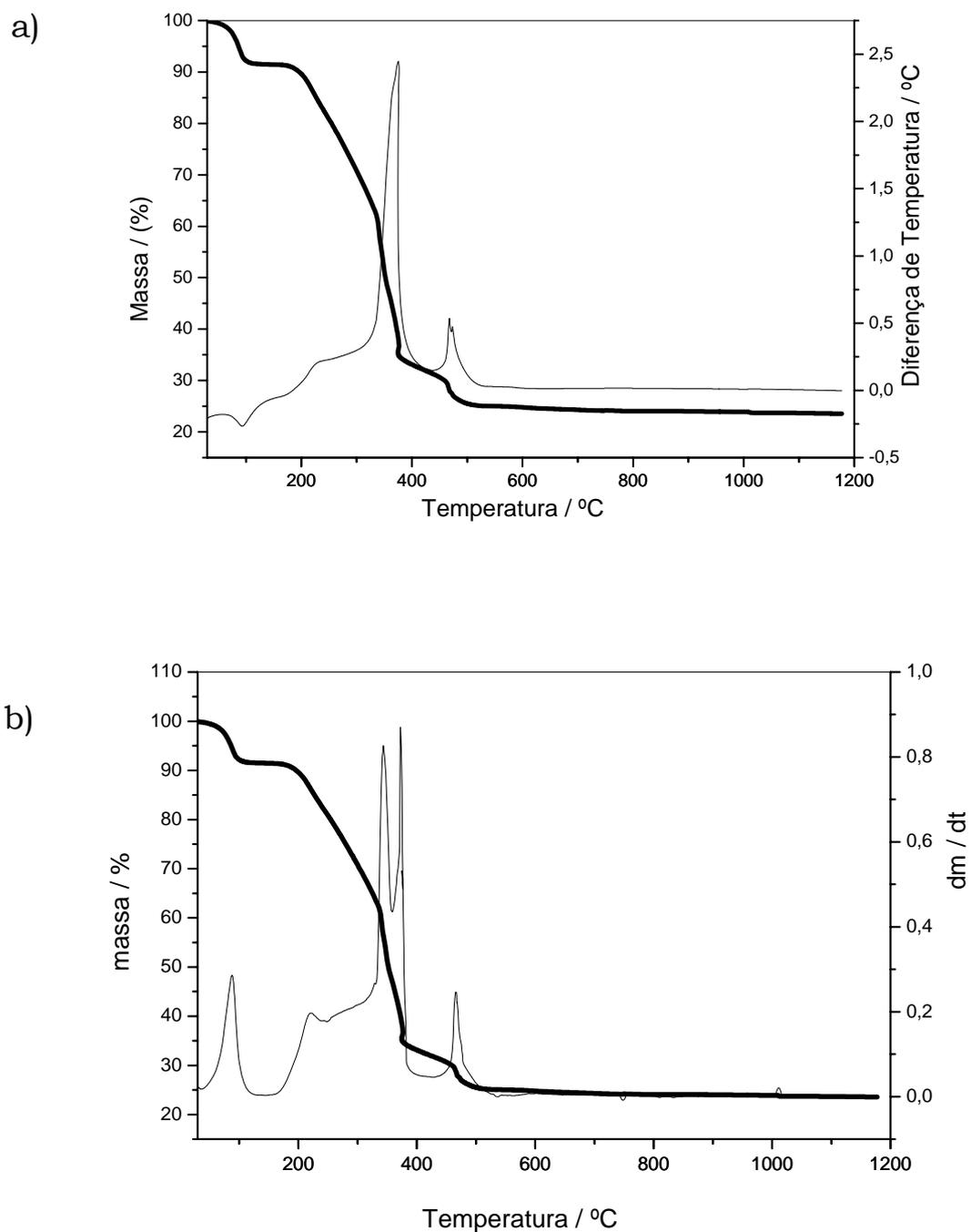
**Figura 29:** Curvas TG, DTA e DTG do 2-metoxibenzalpiruvato de Hômiu, obtidos em atmosfera de ar sintético, fluxo de  $100 \text{ mL min}^{-1}$ , razão de aquecimento de  $20^\circ\text{C min}^{-1}$ , cadinho de Platina. a) Curvas TG-DTA; b) curvas TG/DTG.
