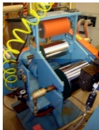
**Figura 2.13 – Sistema de calandragem para formação de filmes planos ou laminados.**
