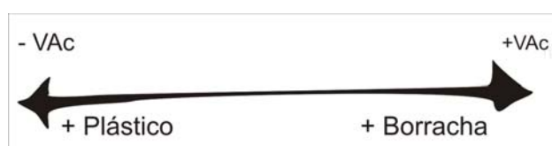
Figura 4. Comportamento do material em função do Teor de Acetato.
