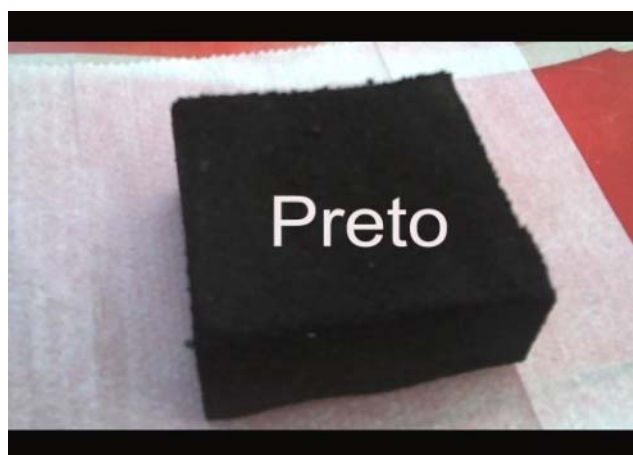
Figura 14. Aglomerado prensado referente ao resíduo de EVA utilizado .
