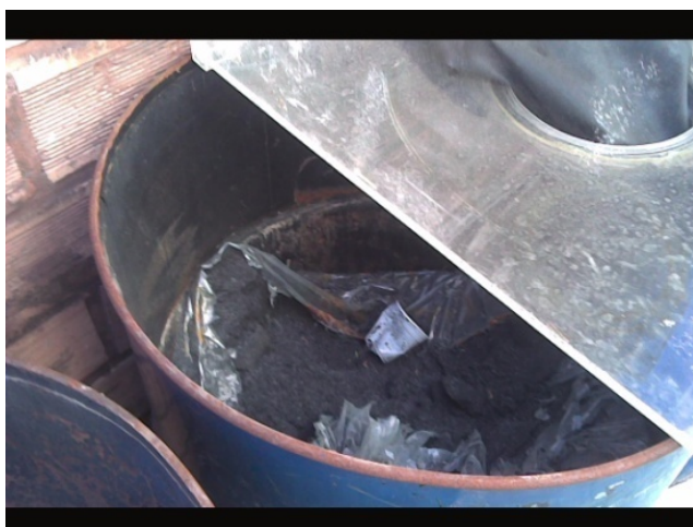
Figura 15. Resíduo depositado a céu aberto em contato com a umidade e outros fatores ambientais.
