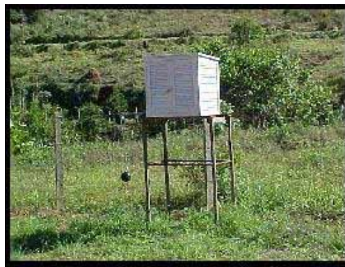
FIGURA 09 - Abrigo meteorológico instalado próximo ao galpão para caracterização do ambiente externo
