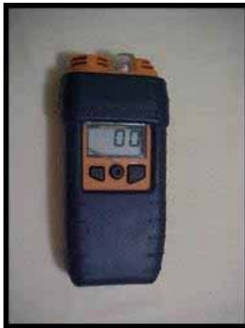
FIGURA 10 - Sensor utilizado para detectar a concentração de amônia no ar dentro do galpão experimental
