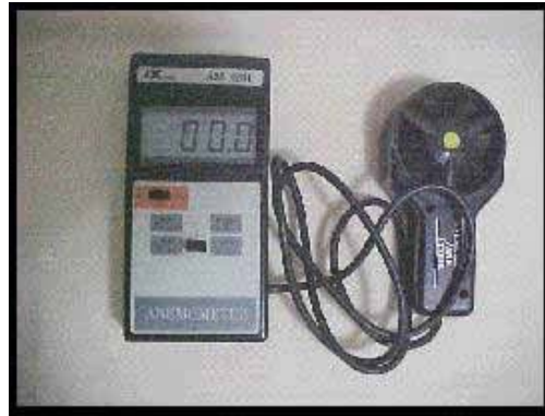
FIGURA 08 - Anemômetro digital de hélice utilizado nas leituras de velocidade do ar
