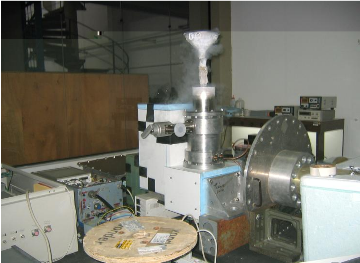
Figura 3.29 - Polar metro inteiramente montado na bancada, operando em temperaturas criogênicas.
