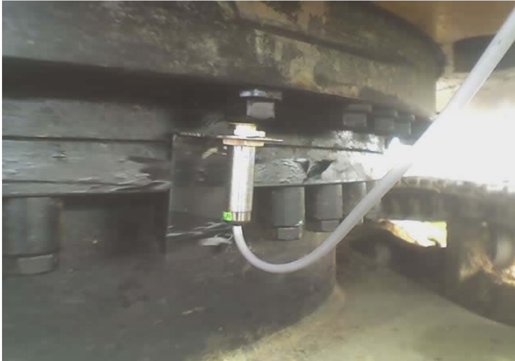
Figura 4 – Localização do sensor na base da máquina.
