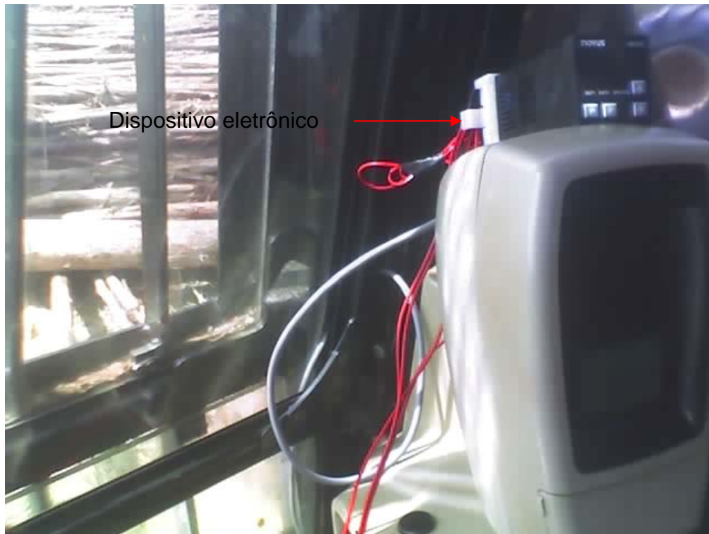
Figura 6 – Vista do contador no interior da cabine.
