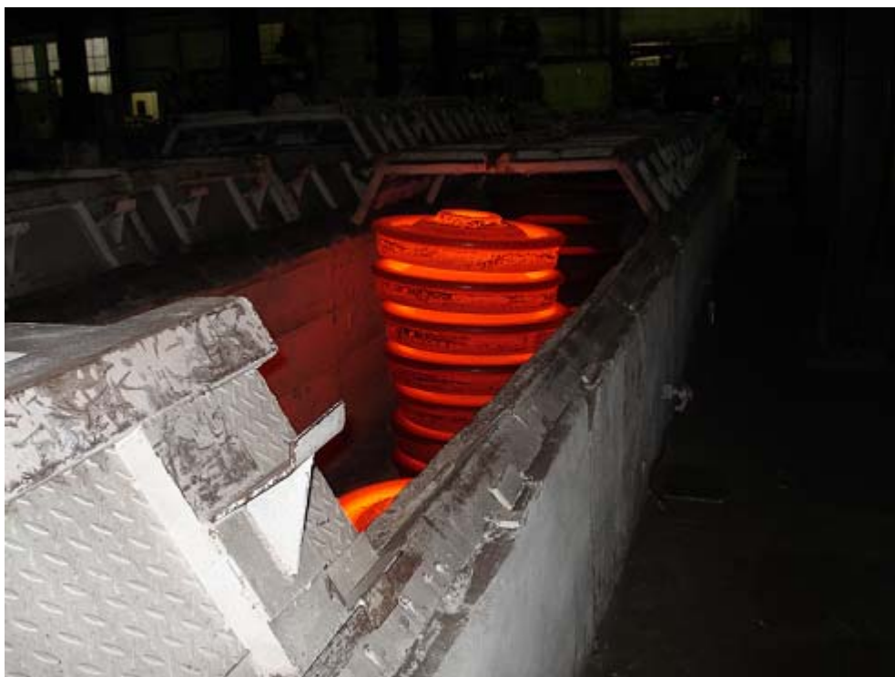
Figura 38 – Fossa de resfriamento controlado.
