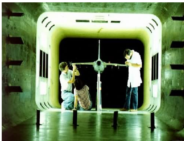
Figura 5.3 - Montagem do modelo aerodinâmico na seção de ensaios do TA-2 (IAE, 2005).
