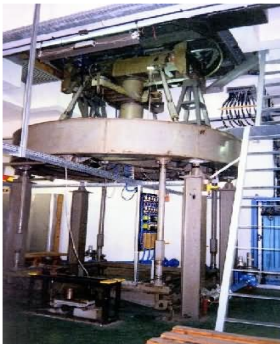
Figura 5.6 - Balança externa do túnel de vento (IAE, 2005).
