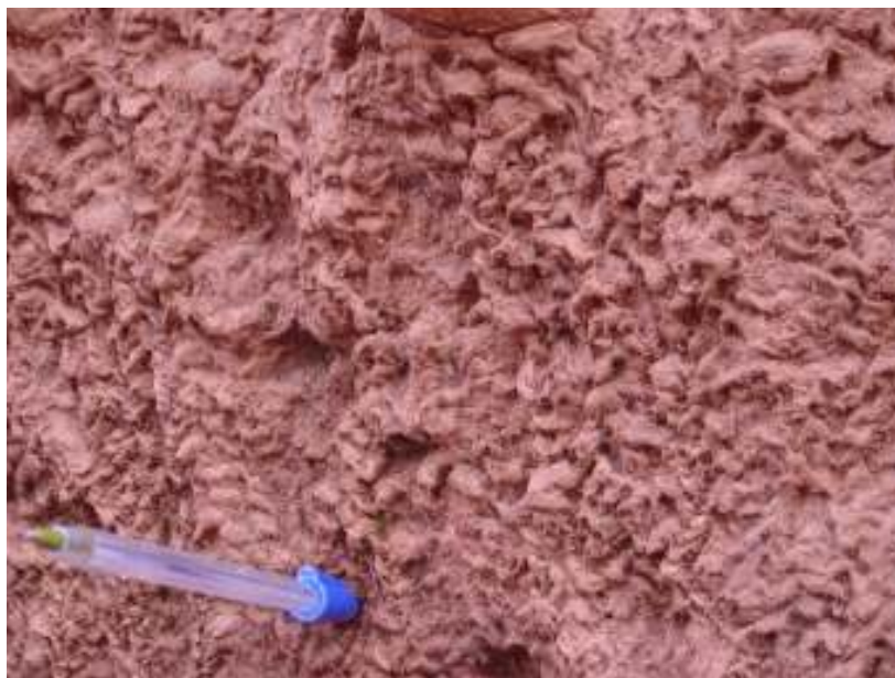
Fig. 26 – Presença de escamas na superfície vertical das paredes da voçoroca (ALVES – Abril de 2005).
