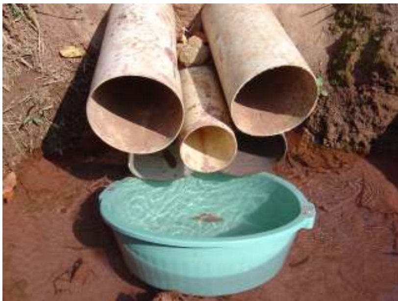
Fig. 8 – Esta figura representa a coleta de uma amostra de sedimento arrastado pelo fundo do canal. (ALVES – Setembro de 2004).
