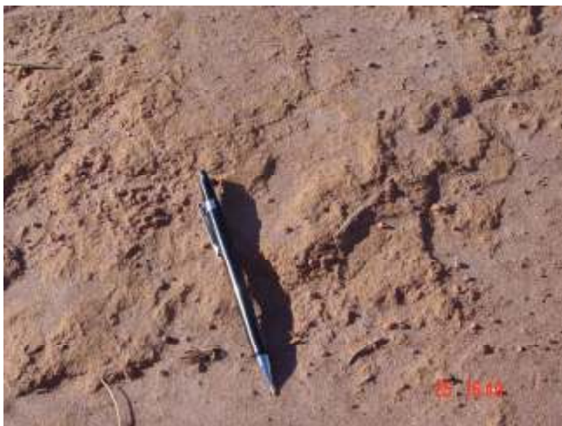
Fig. 20 – Solo às margens da voçoroca já atacado pela ação do efeito “splash”. Observe que o solo apresenta-se compactado e com partículas desagregadas em sua superfície (ALVES – Maio de 2004).
