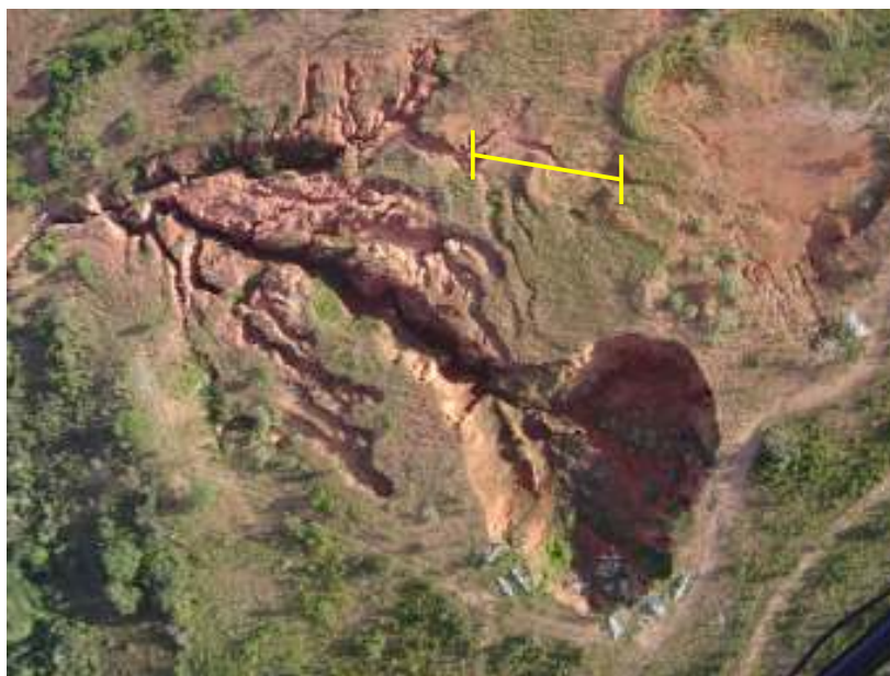
Fig. 23 – Na cor amarela está indicado o comprimento total que a voçoroca avançou durante o tempo da pesquisa (ALVES – Junho de 2004).
