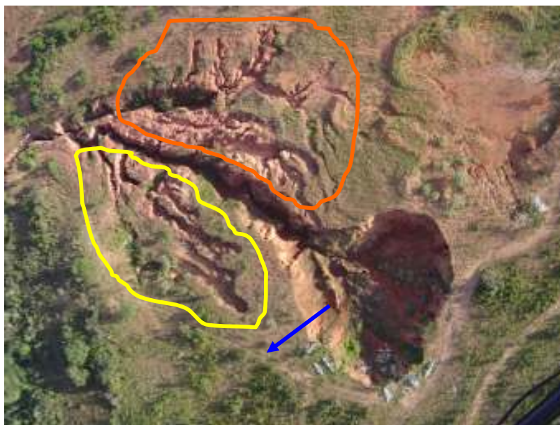
Fig. 21 – A área circulado em amarelo representa os canais da margem esquerda conectados ao canal principal da voçoroca e a seta azul representa uma estrada que diminui a área de contribuição desta margem. Já a área circulado em laranja engloba os canais conectados da margem direita (ALVES – Junho de 2004).
