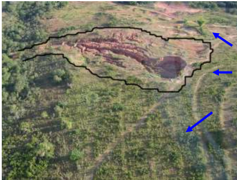
Fig. 16 – As setas azuis indicam o direcionamento do fluxo divergente da vertente convexa da colina. A região envolvida pela linha preta indica onde ocorre a vertente côncava sobre a convexa, local em que o fluxo deixa de ser divergente e passa a ser convergente. (ALVES – Junho de 2004).
