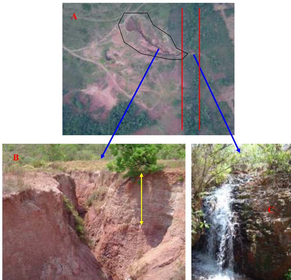
Fig. 13 – O espaço existente entre as linhas vermelhas na figura A representa a região onde afloram os basaltos e fora destas duas linhas está a área do arenito. A área circulado em preto indica a voçoroca. A figura B mostra uma região do canal da voçoroca onde há arenito recoberto por uma camada de seixos rolado que se estende até a superfície (seta amarela). Por fim, a figura C ilustra a Formação Basáltica presente no leito do canal para onde flui a voçoroca (ALVES – Junho de 2004).
