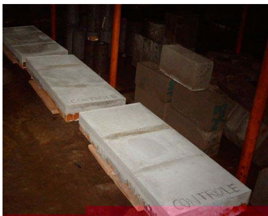
Figura 25: Desmoldagem e cura dos modelos M-100
