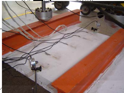
Figura 40: Transporte dos modelos e posicionamento dos relógios comparadores
