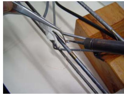
Solda dos terminais
