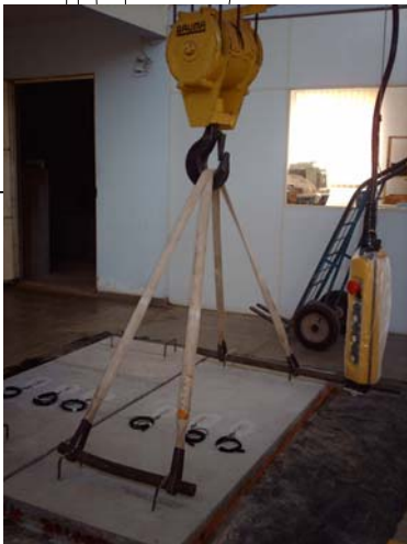
Figura 40: Transporte dos modelos e posicionamento dos relógios comparadores
