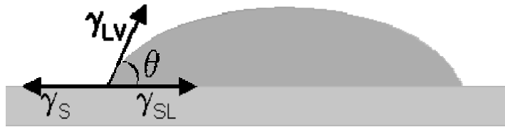
Figura 1 – Ângulo de contato ( \theta ) entre uma gota e uma superfície plana e horizontal. As tensões superficiais da superfície do sólido, do líquido em equilíbrio com o vapor e superfície e líquido, respectivamente, \gamma_s , \gamma_{LV} e \gamma_{SL} .
