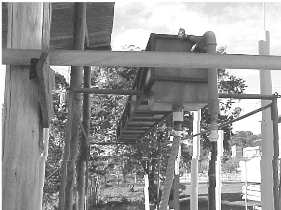
Figura 16. Simulador de chuvas utilizado no experimento.
