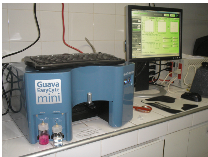
Figura 12: Citômetro de fluxo utilizado nos ensaios de determinação da integridade da membrana celular, avaliação do ciclo celular e fragmentação do DNA
