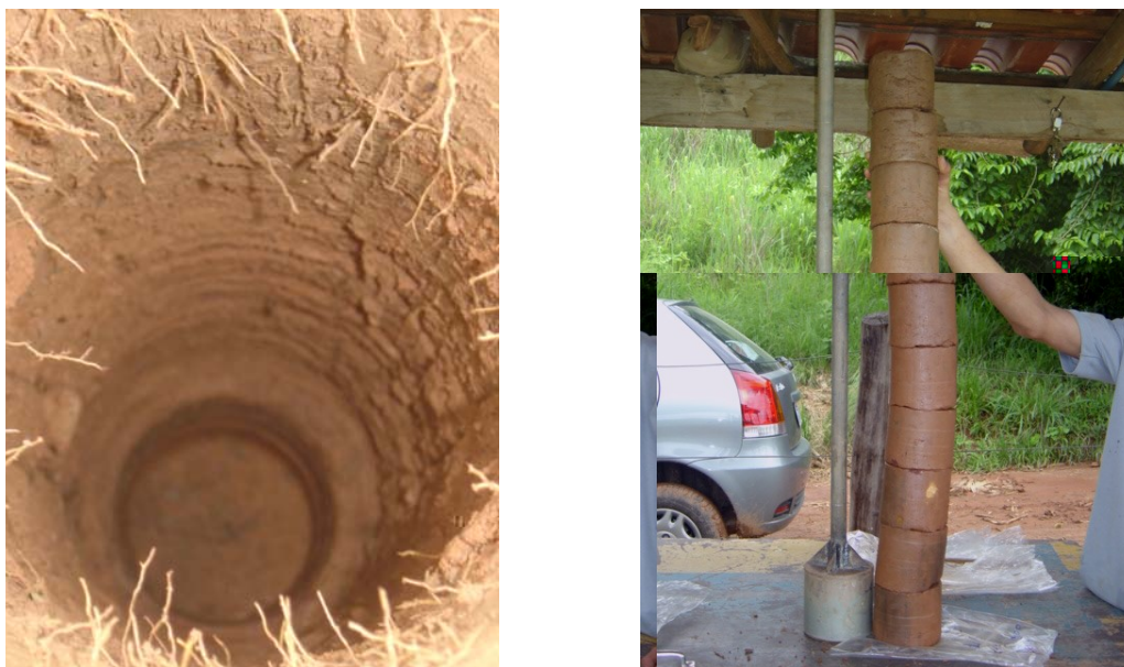
Figura 21 – Detalhe do local e perfil amostrado em camadas sucessivas com 10 cm de profundidade até 1,00 m.
