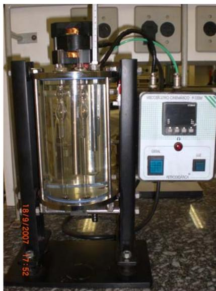
**FIGURA 17** – Viscosímetro cinemático utilizado na análise dos ésteres etílicos obtidos através de reações de transesterificação enzimática utilizando a Lipozyme TL IM.
