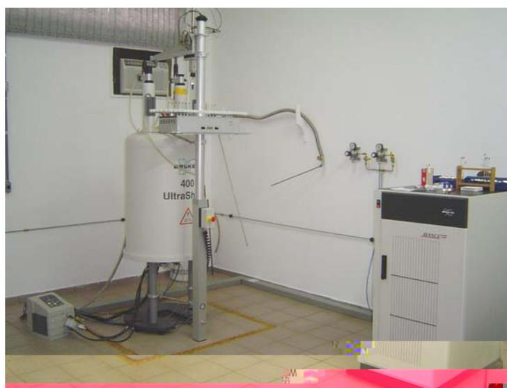
**FIGURA 15** - Espectrômetro Bruker DRX 400 utilizado para as análises de RMN  $^1\text{H}$  e  $^{13}\text{C}$  do presente trabalho. Propriedade da FFCLRP-USP.
