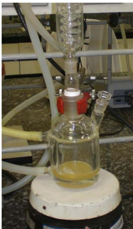
**FIGURA 19.b** - Reator utilizado nas reações de transesterificação dos óleos de soja e mamona a 40°C utilizando etanol e Lipozyme TL IM como catalisador enzimático.
