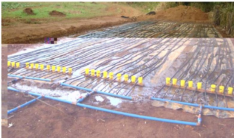
**Figura 3** - Vista da avaliação da uniformidade de aplicação de água no sistema de irrigação por gotejamento abastecido com água ferruginosa.
