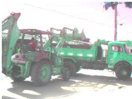
**Figura 6.31. Caminhão caçamba e máquina pá carregadeira – coleta de entulho.**
