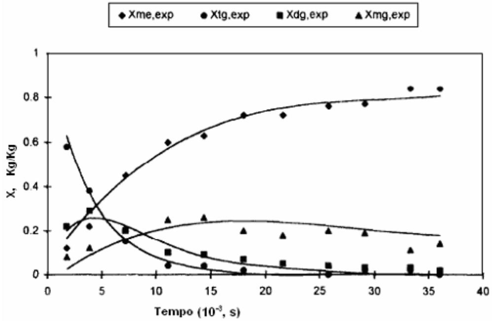
**Figura 5.** Cinética da transesterificação de triglicerídeos (DIASAKOU et al.,1998). Xme = , Xtg, Xdg, Xmg são as frações mássicas dos ésteres metílicos, triglicerídeos, diglicerídeos e monoglicerídeos, respectivamente.
