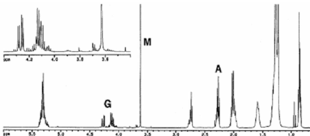
**Figura 17.** Espectro Ressonância Magnética Nuclear de Hidrogênio de uma reação de transesterificação de triglicerídeos em andamento (cinco minutos) (KNOTHE, 2000).
