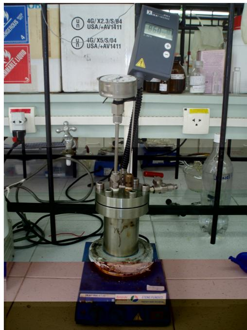
**Figura 15.** Reator pressurizado de aço inoxidável (vaso de pressão) – RP.
