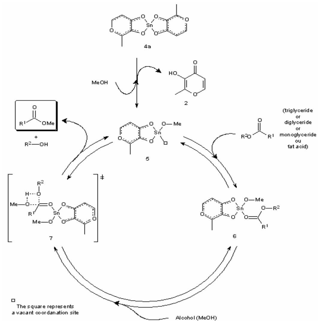
**Figura 13.** Ciclo catalítico proposto para o complexo  $\text{Sn}(\text{C}_6\text{H}_5\text{O}_3)_2(\text{H}_2\text{O})_2$  (DaSilveira Neto et al., 2007).
