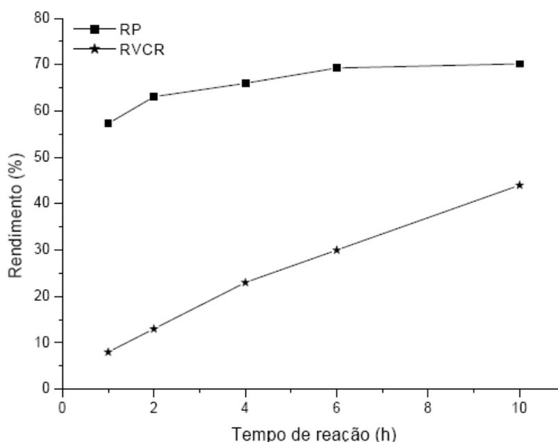
**Figura 24.** Rendimento em FAMES (%) obtidos pela metanólise do óleo de soja empregando-se dois diferentes tipos de reatores: Reator pressurizado de aço inoxidável – RP e Reator de vidro acoplado a um condensador de refluxo - RVCR. As condições de reação foram: razão molar 400:100:1 para o metanol, óleo de soja e dibutil diacetato de estanho, respectivamente; temperatura: 80 °C e agitação magnética constante: 1000 rpm .
