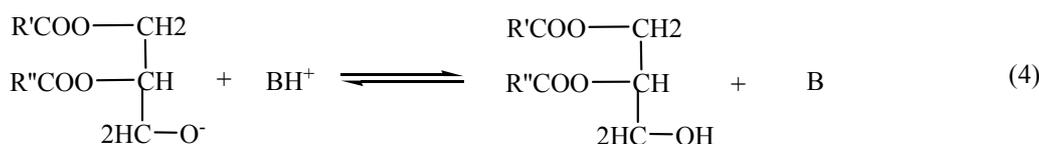
**Figura 6.** Mecanismo da transesterificação de óleos vegetais catalisada por base (SCHUCHARDT et al., 2004).
