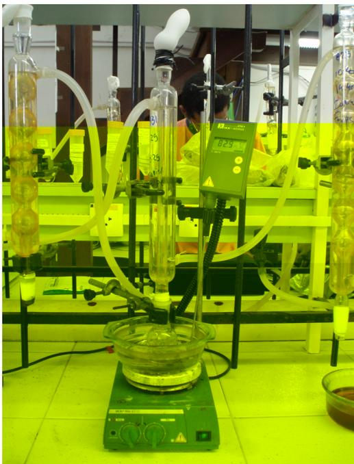
**Figura 14.** Reator de vidro acoplado a um condensador de refluxo - RVCR.
