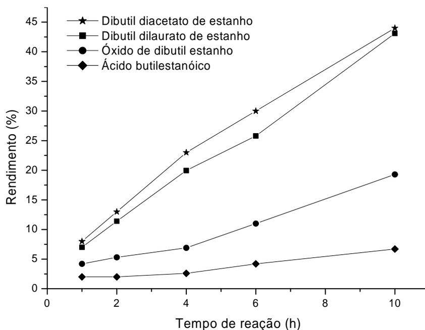
**Figura 23.** Rendimento em FAMES (%) na metanólise do óleo de soja na presença de catalisadores de estanho(IV). As condições de reação foram: razão molar 400:100:1 para o metanol, óleo de soja e catalisador, respectivamente; temperatura: 80 °C, RVCR e agitação magnética constante: 1000 rpm.
