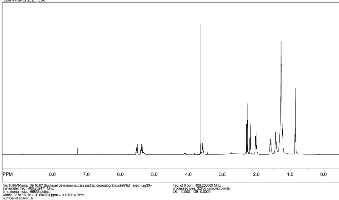
**Figura 20.** Espectro da Ressonância Magnética Nuclear de Hidrogênio de uma amostra do biodiesel de mamona empregado como padrão em análises de cromatografia gasosa.
