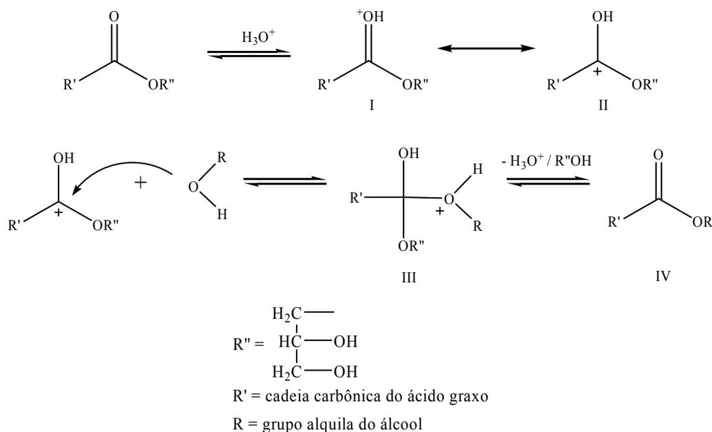
**Figura 10.** Mecanismo da transesterificação de óleos vegetais catalisada por ácido (SCHUCHARDT et al.,2004).
