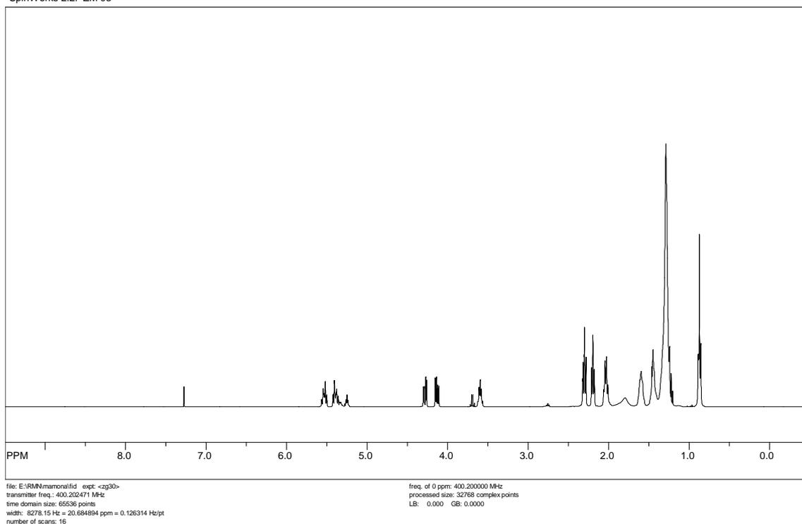
**Figura 19.** Espectro da Ressonância Magnética Nuclear de Hidrogênio de uma amostra de óleo de mamona empregado como padrão em análises de cromatografia gasosa.
