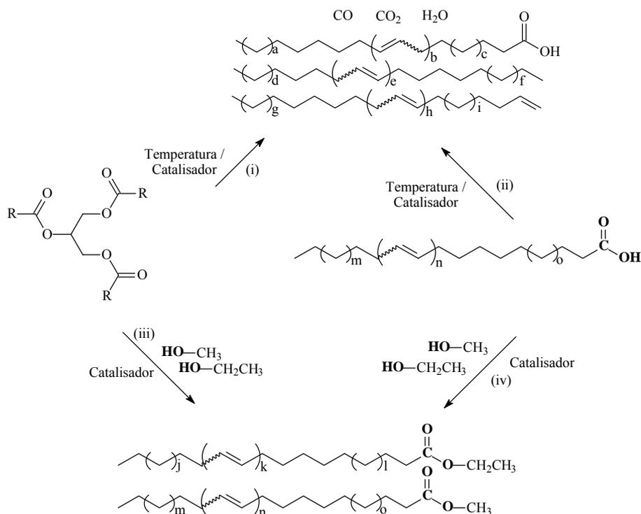
**Figura 1.** Obtenção de combustíveis líquidos a partir de ácidos graxos e triglicerídeos pelas reações de (i) craqueamento de óleos ou gorduras; (ii) craqueamento de ácidos graxos; (iii) transesterificação de óleos ou gorduras e (iv) esterificação de ácidos graxos. Note que as equações não estão balanceadas (SUAREZ e MENEGHETTI, 2007).
