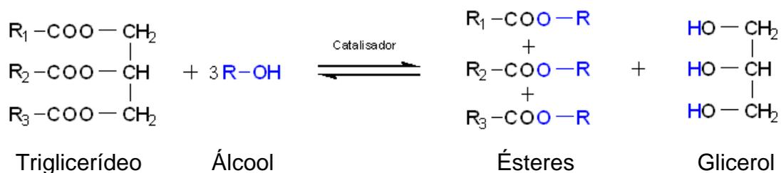
**Figura 3.** Reação global de transesterificação de triglicerídeos (SCHUCHARDT et al.,2004).
