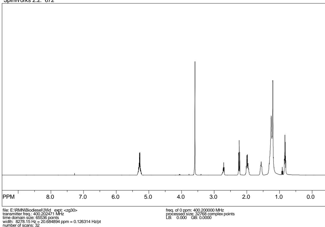
**Figura 18.** Espectro da Ressonância Magnética Nuclear de Hidrogênio de uma amostra do biodiesel de soja empregado como padrão em análises de cromatografia gasosa.
