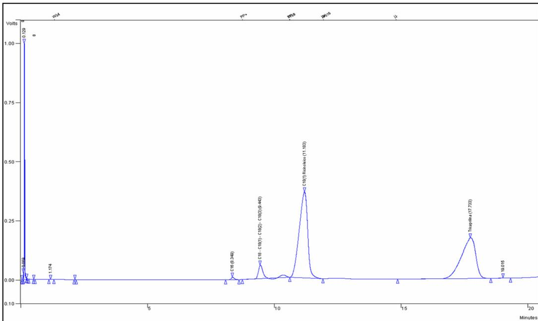
**Figura 22.** Cromatograma de uma amostra do biodiesel de mamona empregado como padrão em cromatografia gasosa.
