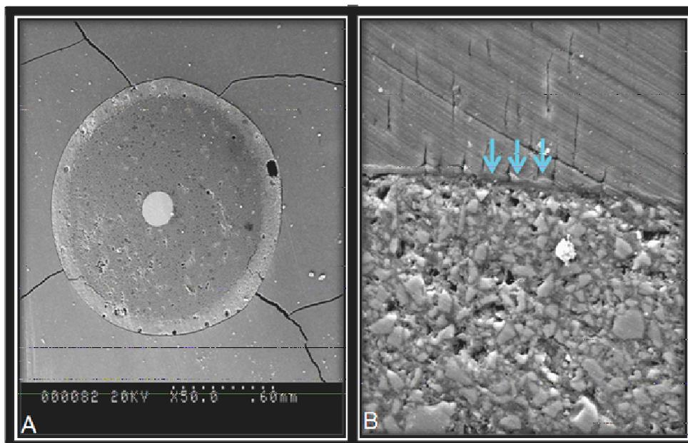
**Figura 12.** Fotomicrografia de espécime com pino Everstick e cimento RelyX Unicem. A) Visão geral da amostra (50X); B) Interface cimento/dentina com aspecto regular e fendas menos expressivas (500X).
