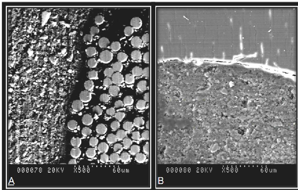
**Figura 11.** Fotomicrografias de espécime com pino Everstick e cimento Panavia F. A) Interface pino/cimento demonstrando ausência de espaços (500X); B) Interface cimento/dentina apresentando aspecto homogêneo da interface (500X).
