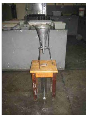
FOTO 3.5: ENSAIO DE CALDA
