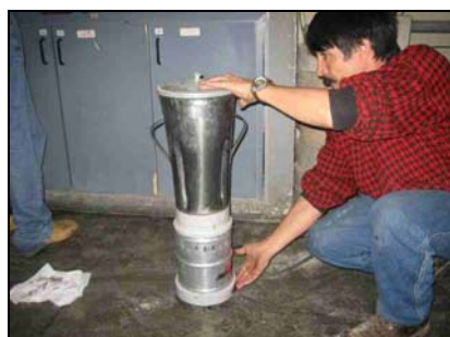
FOTO 3.4: ENSAIO DE CALDA
