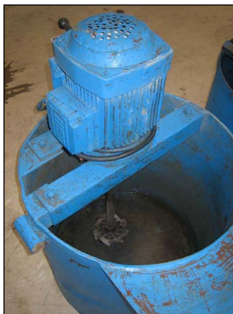
FOTO 2.19: MISTURADOR DE CALDA DE CIMENTO FONTE: PROTENDE, 2006
