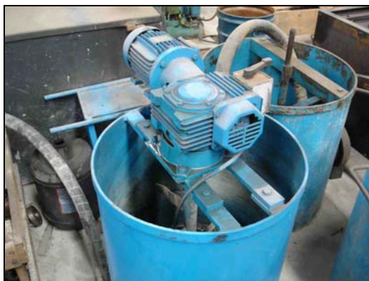
FOTO 2.20: AGITADOR DE CALDA DE CIMENTO FONTE: PROTENDE, 2006
