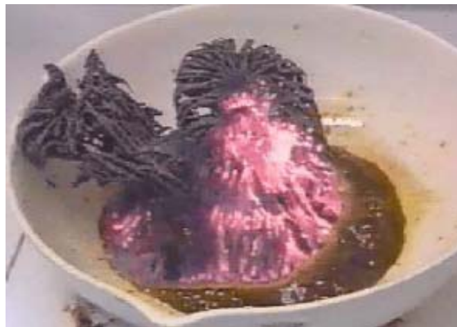
FIG. 4.1 Auto-combustão da amostra (THOMPSON, SHIRTCLIFFE, O'KEEFE, APPLETON e PERRY, 2005).
