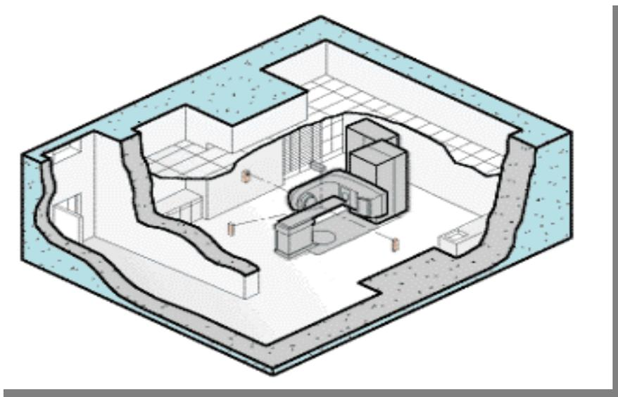
Figura 2.10 – Leiaute de uma sala de radioterapia típica, com ilustração do acelerador, labirinto e porta.
