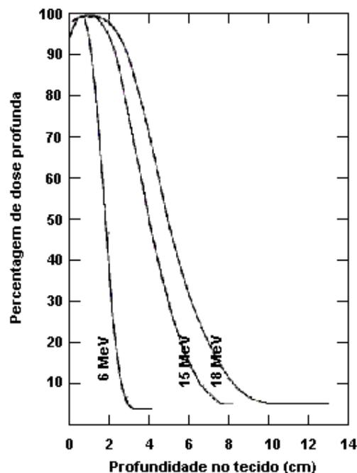
Figura 1.2. Percentagem de dose profunda, para feixes de 6, 15 e 18 MeV, em função da profundidade no tecido (Schaberle *et al*, 2000).
