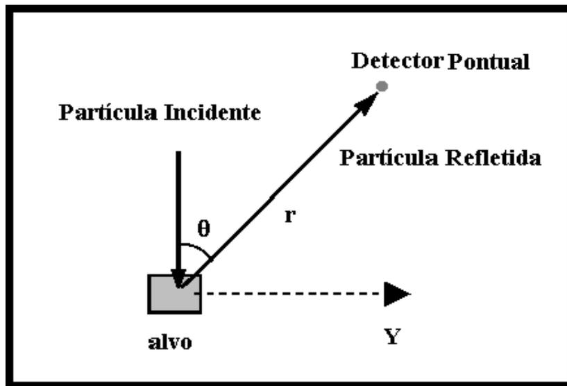
Figura 3.2. Configuração geométrica adotada para o cálculo das fluências e energias médias dos nêutrons espalhados por diferentes tipos de superfícies.  $\theta$  é o ângulo de reflexão e  $r$  é a distância do centro da barreira ao detector.
