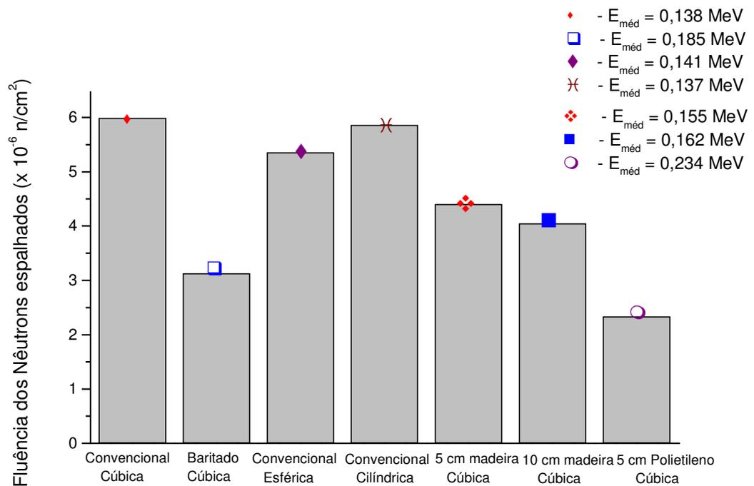
Figura 4.15 – Ilustração das fluências espalhada e térmica, considerando-se vários formatos de salas e diferentes materiais aderidos às paredes.
