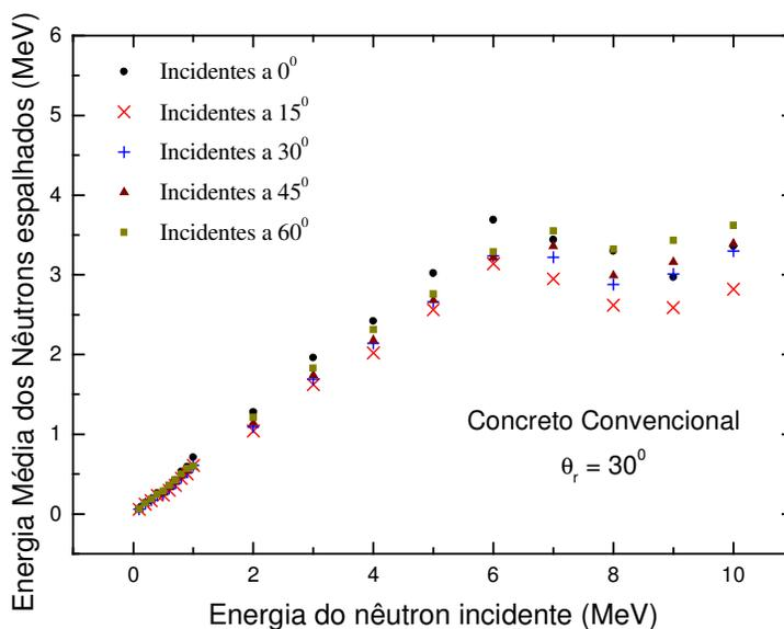
Figura 4.11 – Variação na energia média dos nêutrons espalhados em função do ângulo de incidência. Considerou-se o ângulo de  $30^\circ$  como ponto de detecção das partículas (ângulo de reflexão).
