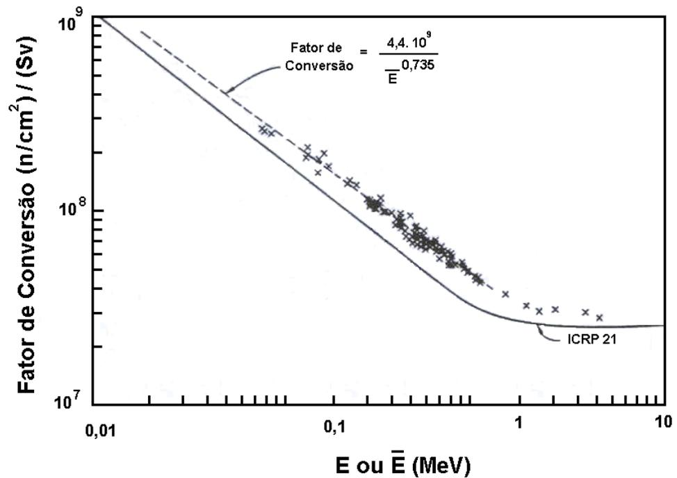
Figura 2.7 – Fatores de conversão fluência-equivalente de dose, em função das energias médias dos nêutrons (NCRP, 1984).
