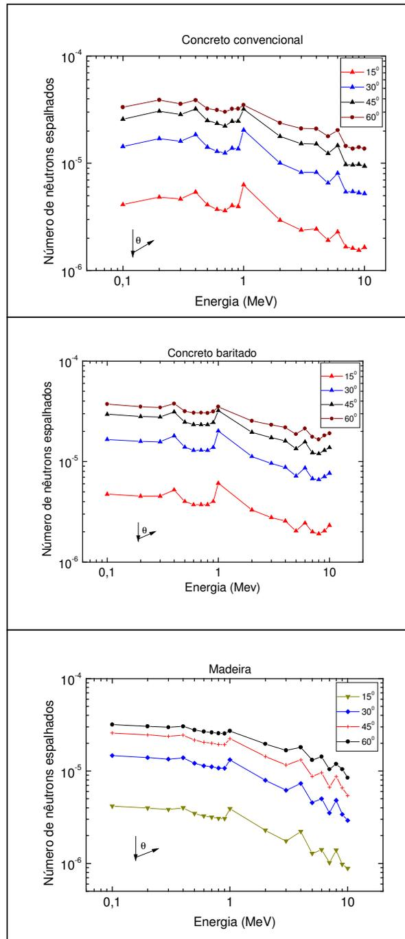
Figura 4.10 – Número de nêutrons espalhados a diferentes ângulos, em função da energia da partícula incidente, para o concreto convencional, baritado e madeira (Facure *et al.*, 2005b).
