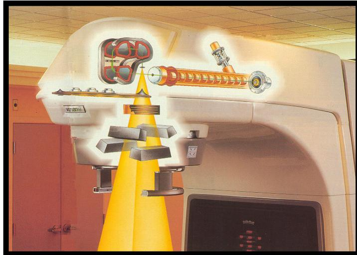
Figura 1.3 - Principais componentes de um Acelerador Linear
