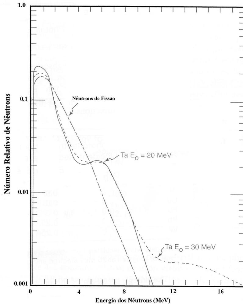
Figura 2.3 – Espectro de fotonêutrons produzido pela colisão de raios-X de 20 e 30 MeV com um alvo de tântalo (Ta). Um espectro de nêutrons de fissão é ilustrado, para comparação. (NCRP, 1984)
