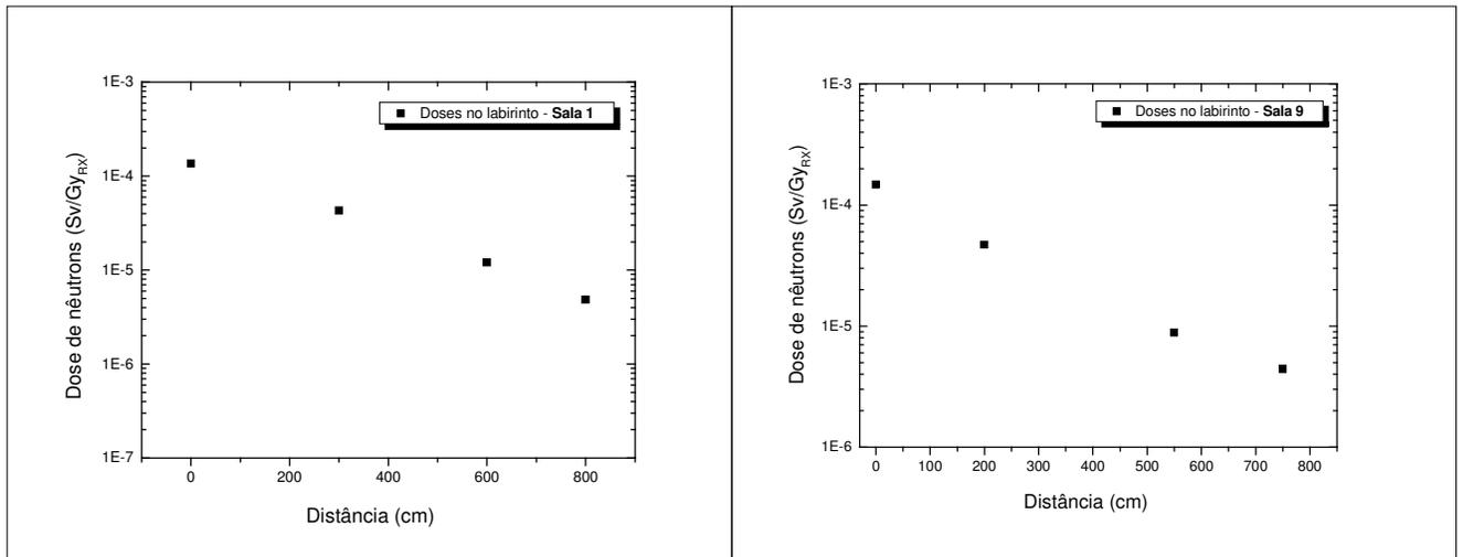
Figura 4.19– Ilustração do decréscimo no equivalente de dose de nêutrons no interior do labirinto de duas salas simuladas no presente trabalho. Para a sala 1, o valor da distância deci-redutora obtida foi de, aproximadamente, 6,0 m; para a sala 9 a distância estimada foi de, aproximadamente, 4,5 m.
