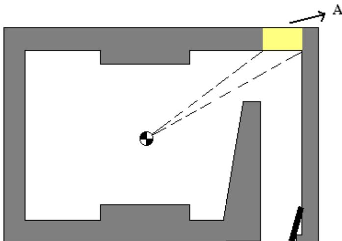
Figura 2.12 – Ilustração de uma determinada área A, que pode ser vista da porta da sala, irradiada diretamente por nêutrons provenientes do acelerador.
