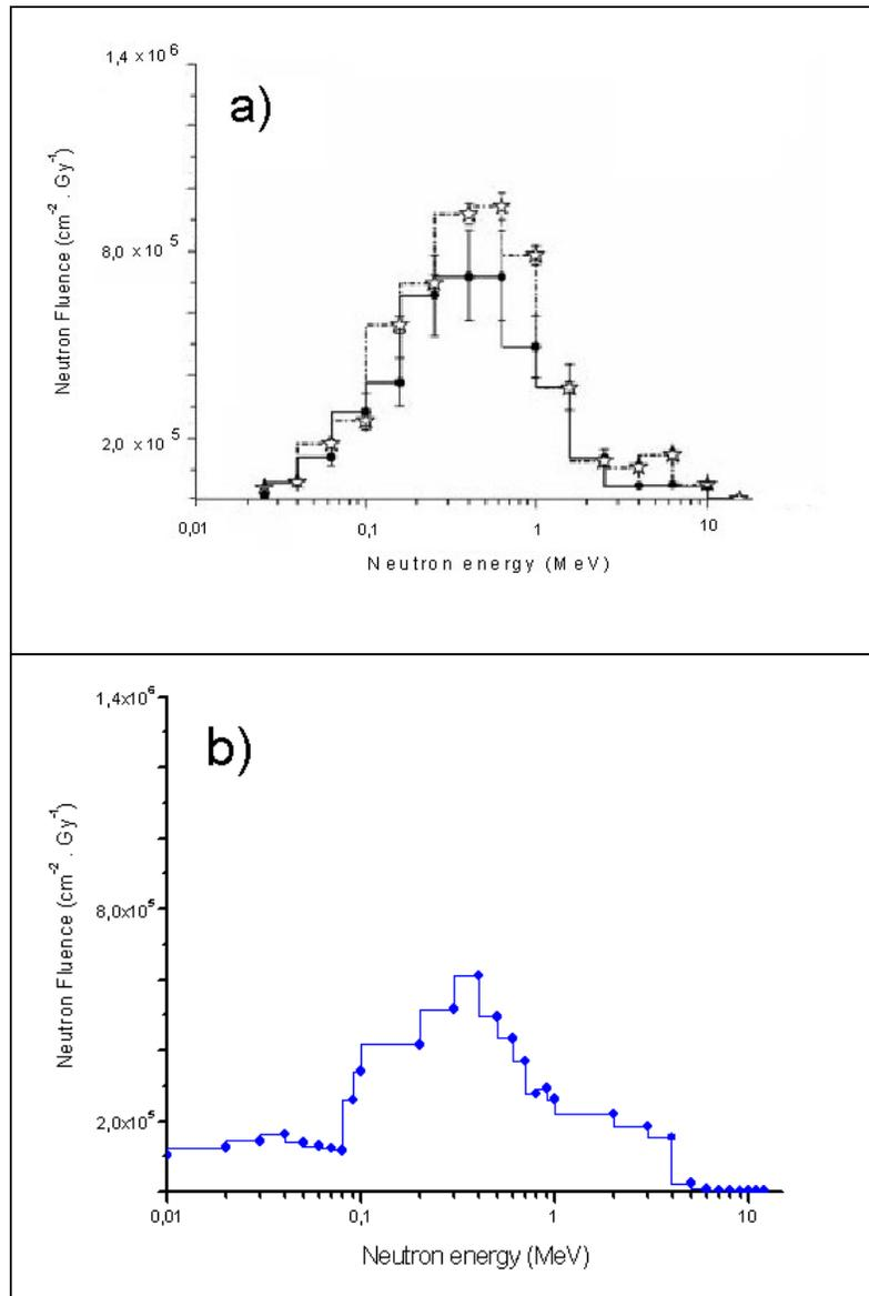
Figura 4.18 – a) Fluência de nêutrons no plano do paciente (100 cm), produzida por um acelerador *Electa SLi*, de 18 MV. Os pontos pretos referem-se às medidas experimentais, realizadas com detectores de bolhas, e as estrelas correspondem ao espectro simulado (Zanini *et al*, 2004). b) Espectro de nêutrons no plano do paciente, simulado neste trabalho. Considerou-se o mesmo acelerador que o acima descrito, no interior da sala 12.
