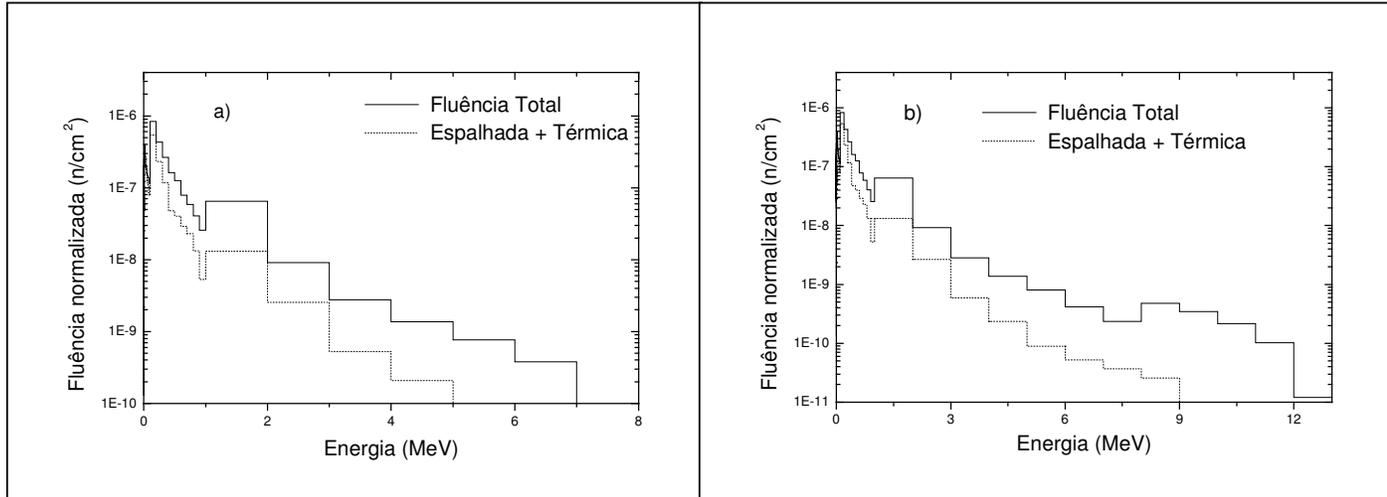
Figura 4.13 – Ilustração das fluências espalhada, térmica e a fluência total, detectadas a um ponto distante 250 cm da fonte, para aceleradores de a) 15 MV e b) 20 MV
