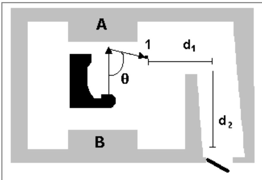
Figura 4.24– Ilustração dos parâmetros utilizados na proposta alternativa da estimativa de equivalentes de dose de nêutrons na entrada de salas de tratamento.
