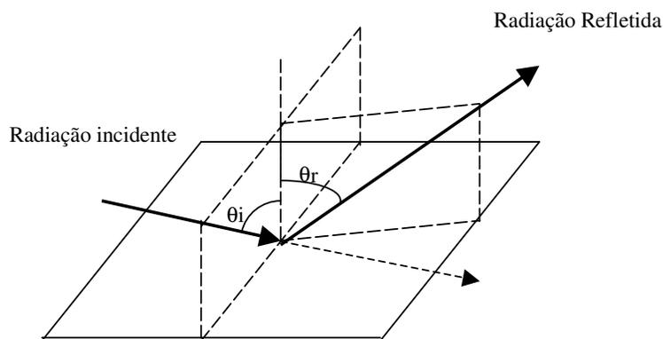
Figura 2.13 – Ângulos de incidência,  $\theta_i$ , e reflexão,  $\theta_r$ , utilizados nos cálculos das doses-albedo, propostos por French e Wells (French e Wells, 1964).
