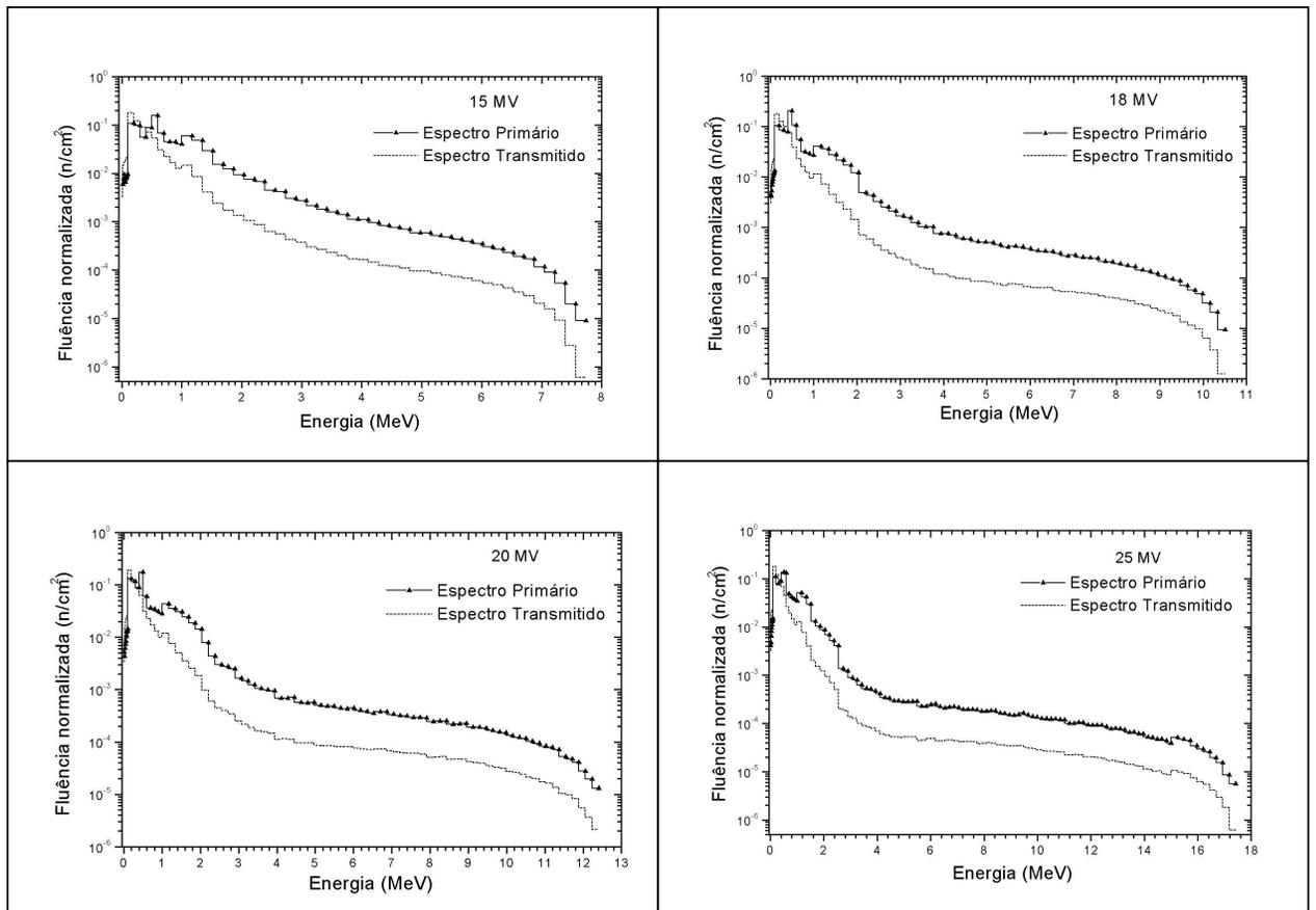
Figura 4.2 – Espectros primários e transmitidos (*leakage*) por aceleradores genéricos, de diferentes megavoltagens (Facure *et al*, 2005a).
