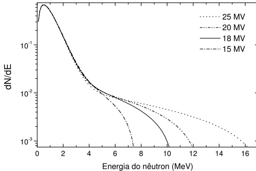
Figura 3.1 – Espectros de nêutrons primários, obtidos através da equação 2.3, gerados no interior dos cabeçotes dos aceleradores estudados.
