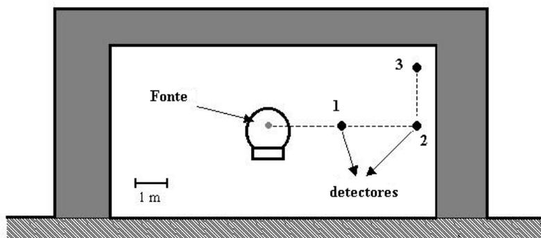
Figura 3.3 – Ilustração do posicionamento dos detectores utilizados nas simulações das componentes espalhada e térmica (Facure et al, 2005c).
