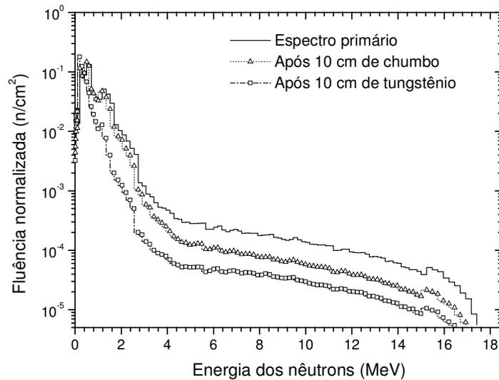
Figura 4.1 – Ilustração da degradação de um espectro de nêutrons, produzido em um acelerador de 25 MV, que ocorre após o mesmo atravessar uma blindagem esférica de 10 cm de chumbo ou tungstênio (Facure *et al*, 2004).
