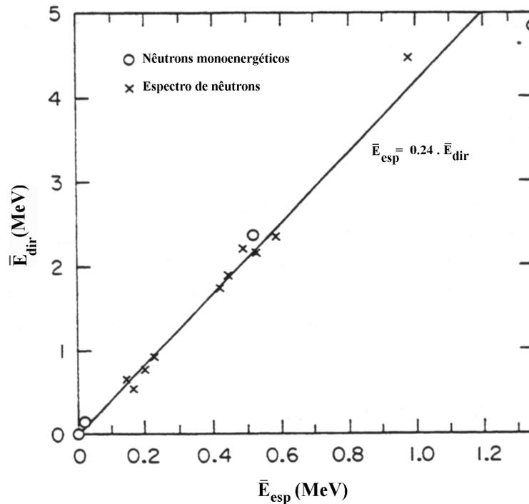
Figura 2.8 –Relação existente entre as energias médias do espectro primário de nêutrons e o espectro espalhado pelas paredes de uma sala de concreto (NCRP, 1984).
