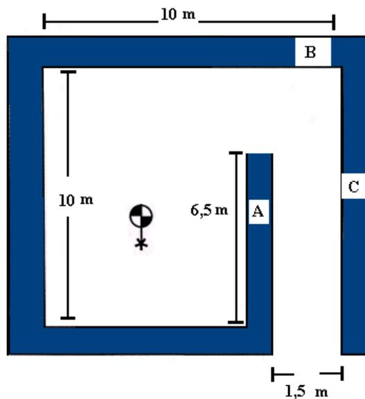
Figura 4.22– Ilustração dos pontos considerados para acréscimo de blindagens de nêutrons, para efeitos de simulações.
