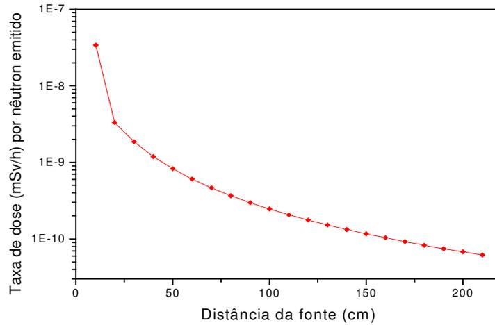
Figura 4.3 – Simulação de taxas de dose de nêutrons *versus* distância, produzidas por um espectro emergente de um acelerador de 15 MV (Facure *et al*, 2004).
