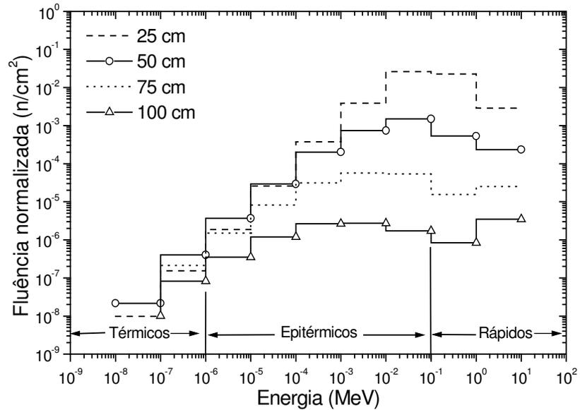
Figura 4.5 – Atenuação de um espectro de nêutrons, produzido em um acelerador de 15MV, após atravessar barreiras de concreto de 25, 50, 75 e 100 cm (Facure et al, 2005a).
