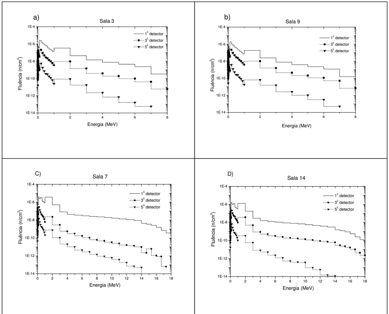
Figura 4.17 – Degradação sofrida pelos espectros de nêutrons, para aceleradores de 15 e 25 MV, desde um ponto situado a 1 m da fonte até a porta a) da sala 3; b) da sala 9; c) da sala 7 e d) da sala 14. Valores normalizados por nêutron emitido da fonte.
