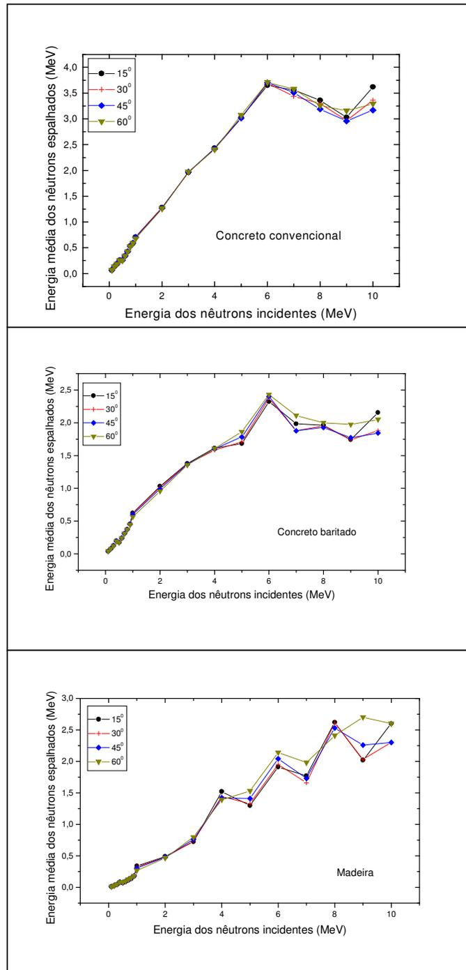
Figura 4.8 – Energias médias dos nêutrons espalhados a diversos ângulos, em função das energias das partículas incidentes (Facure *et al*, 2005b)
