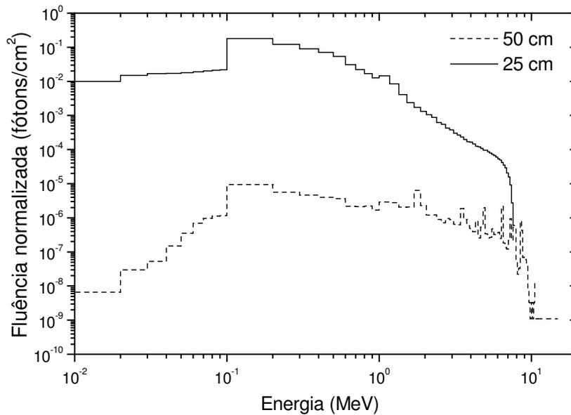
Figura 4.6 – Espectro de raios gama de captura, produzidos por nêutrons provenientes de um acelerador de 15MV (Facure *et al*, 2005a).
