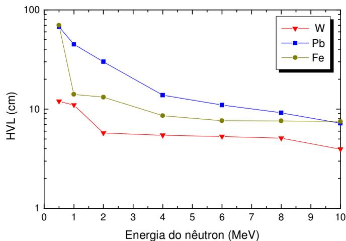
Figura 2.9 – HVL ou espessura da blindagem esférica, de tungstênio, chumbo ou ferro, necessária para reduzir a energia média dos nêutrons emergentes à metade da energia inicial (NCRP, 1984).
