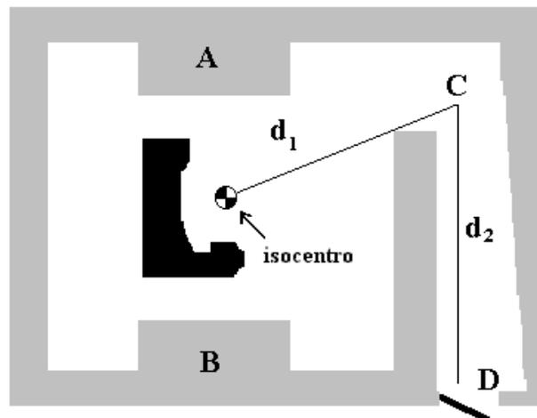
Figura 2.11 – Ilustração dos parâmetros  $d_1$  e  $d_2$ , utilizados no método de *Kersey* para calcular-se as taxas de dose devido aos nêutrons, ao longo de labirintos de salas de radioterapia.
