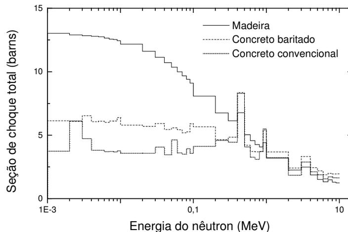
Figura 4.7 – Valores de seção de choque total (barns) em função da energia dos nêutrons incidentes, obtidos através de simulações utilizando o código MCNP.
