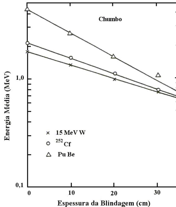
Figura 2.6 – Energia média de vários espectros de nêutrons em função da espessura da blindagem esférica de chumbo que esses atravessam. (McCall *et al*, 1979)
