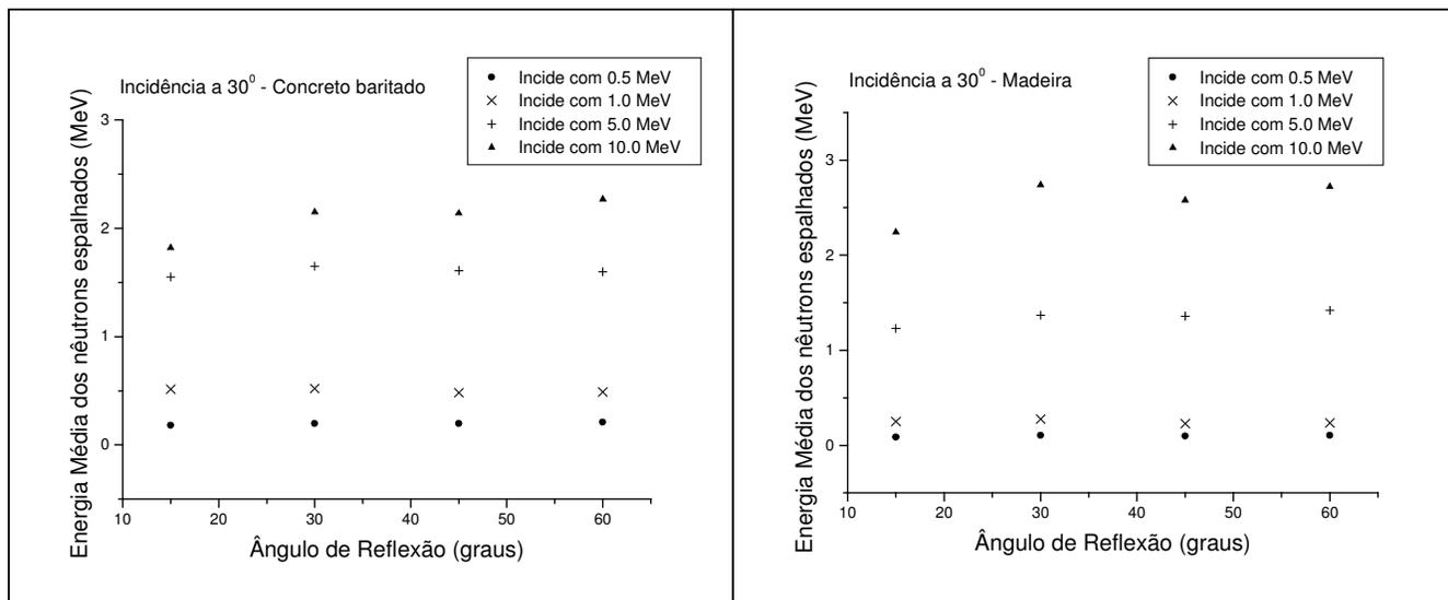
Figura 4.12 – Variação na energia média dos nêutrons espalhados em função da mudança do ângulo de reflexão, para o concreto baritado e madeira.
