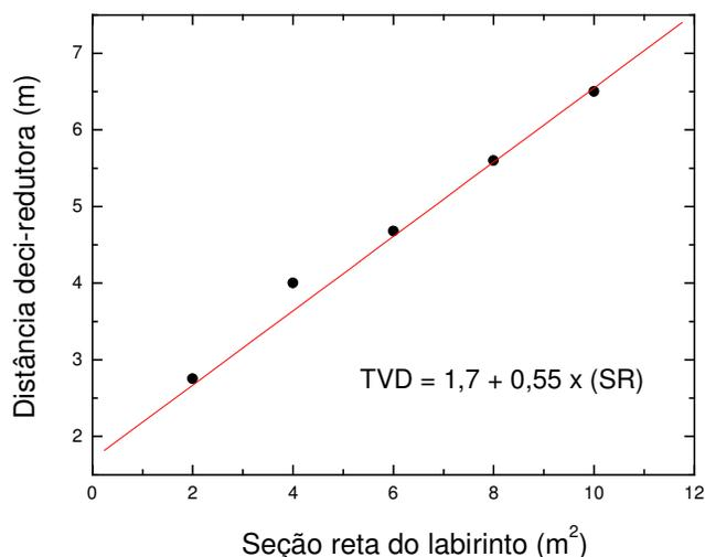
Figura 4.20– Relação existente entre a seção reta do labirinto (SR) e a distância deci-redutora da dose de nêutrons (TVD), para aceleradores de 15 a 25 MV.
