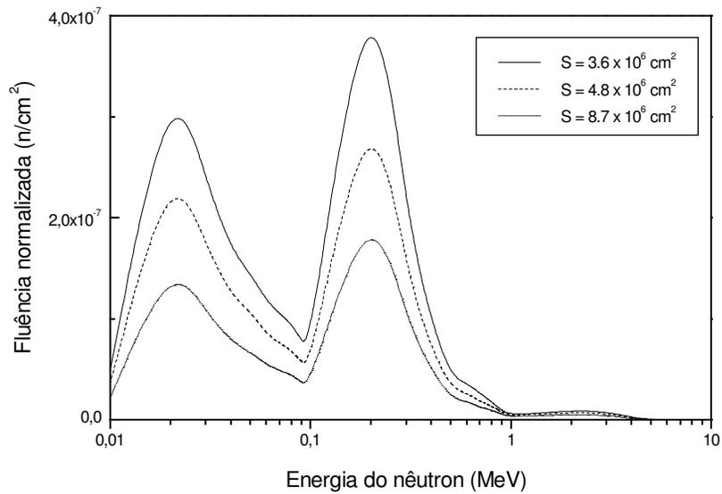
Figura 4.14 – Variação nos espectros de nêutrons espalhados e térmicos com a variação da área superficial das salas.
