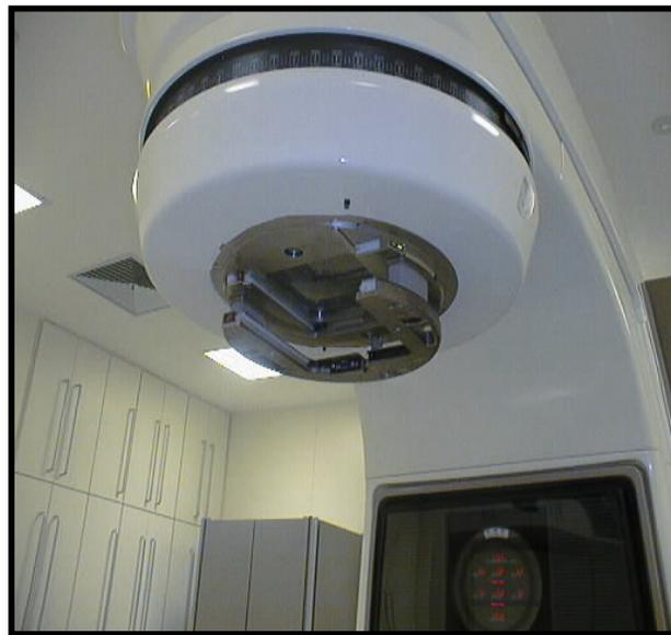
Figura 1.1- Ilustração do cabeçote de um acelerador linear de uso médico
