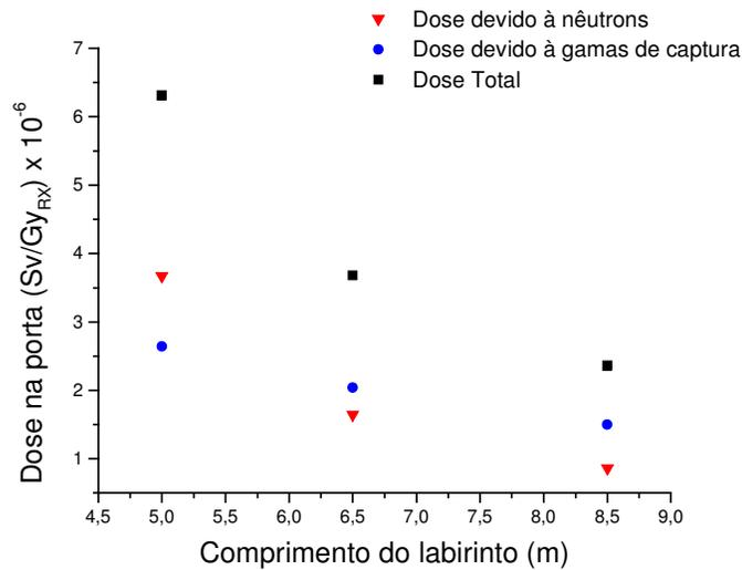
Figura 4.21– Variação que ocorre nos equivalentes de dose devido aos nêutrons e aos raios gama de captura quando se aumenta o comprimento do labirinto.
