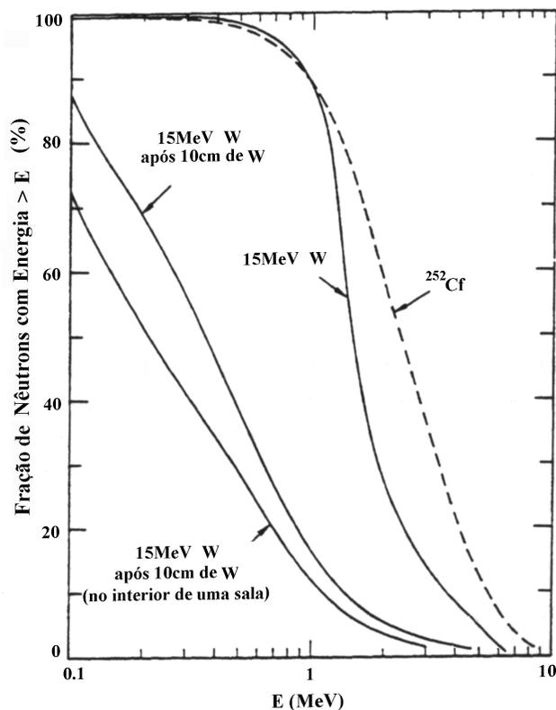
Figura 2.5 – Degradação produzida no espectro de fotonêutrons após uma espessura de 10 cm de tungstênio e após emergir em uma sala de concreto. 15 MeV W representa o espectro de nêutrons produzido quando elétrons de 15 MeV atingem um alvo de tungstênio. (NCRP, 1984)
