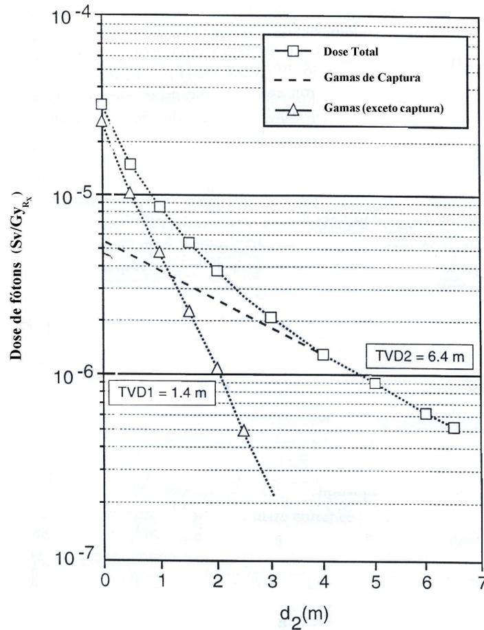
Figura 2.14 –Dose de fótons, por unidade de dose absorvida de raios-X no isocentro, medida em um labirinto de comprimento  $d_2$  (m), para uma sala que abriga um acelerador de 18MV (McGinley *et al*, 1995). TVD<sub>1</sub> e TVD<sub>2</sub> são as distâncias decidoras para as doses produzidas por fótons espalhados e por raios gama de captura, respectivamente.
