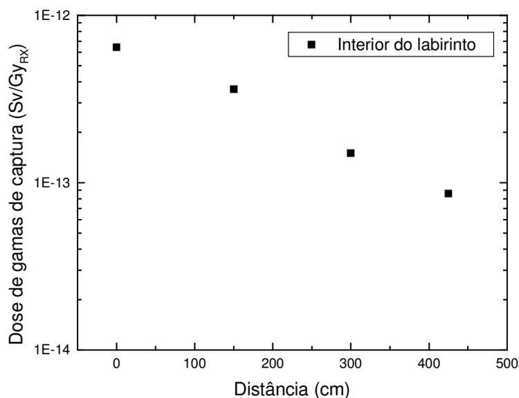
Figura 4.23– Ilustração do decréscimo no equivalente de dose devido aos raios gama de captura no interior do labirinto da sala 9. O valor da distância deci-redutora obtida para esta sala foi de, aproximadamente, 5,0 m.
