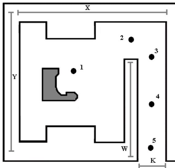
Figura 3.5 – Ilustração dos pontos de simulação das fluências e doses de nêutrons no interior das salas de tratamento.
