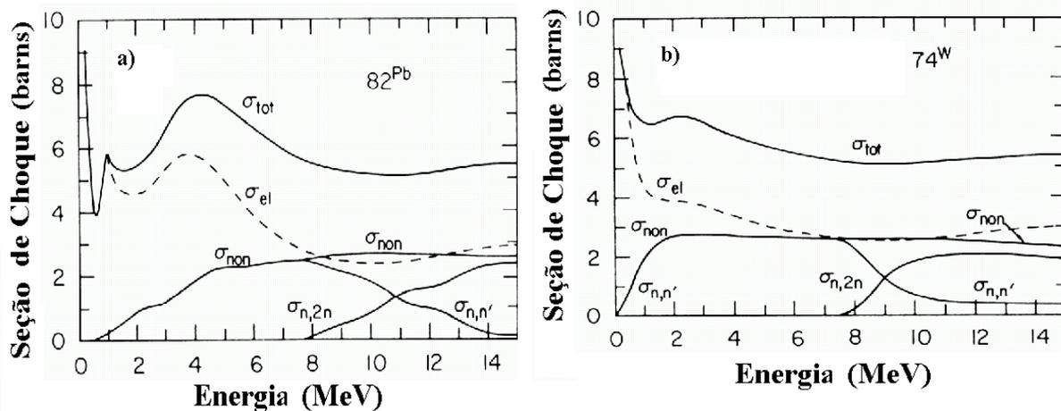
Figura 2.4 – Seções de choque de interação, em função da energia dos nêutrons para o a) chumbo e b) tungstênio.  $\sigma_{\text{non}}$  representa a soma de todas as seções de choque não-elásticas (inelástica + (n, 2n)+..). (NCRP, 1984)
