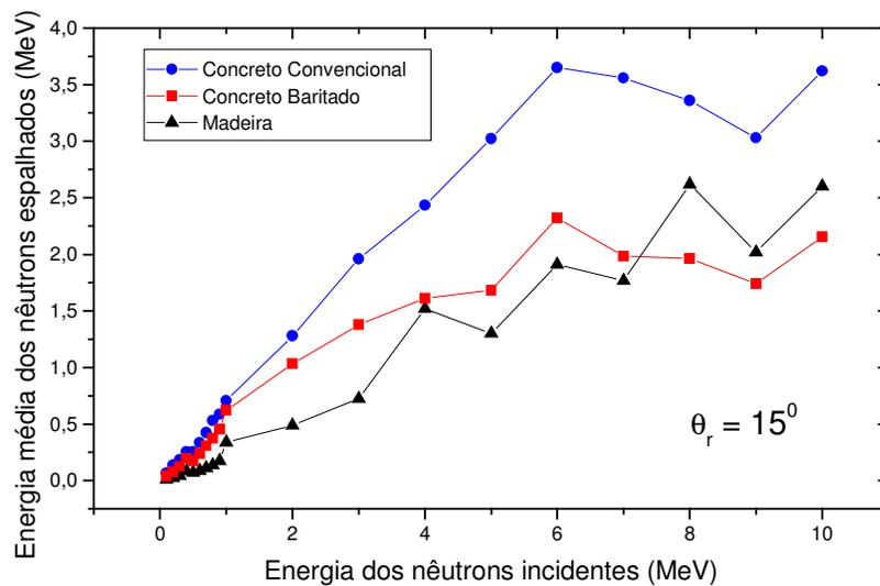
Figura 4.9 – Comparação entre as energias médias dos nêutrons espalhados a  $15^\circ$ , em concreto convencional, baritado e madeira, em função da energia dos nêutrons incidentes nas barreiras.
