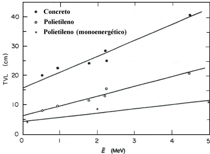
Figura 2.15 – Espessura decimadora (TVL) do equivalente de dose devido à nêutrons, para blindagens esféricas, em função da energia média dos nêutrons primários (NCRP, 1984).
