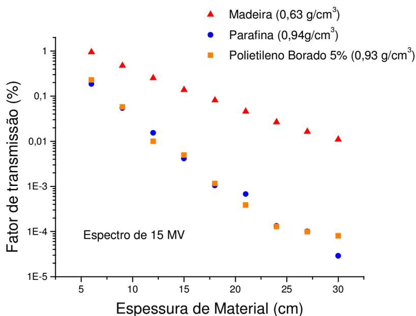
Figura 4.25– Fator de transmissão, em função da espessura de madeira, parafina ou polietileno borado a 5%, para o espectro de nêutrons gerados por aceleradores de 15 MV, na região de entrada das salas de tratamento.
