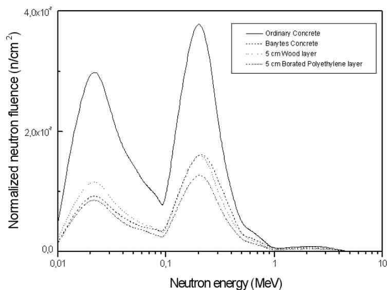
Figura 4.16 - Variação nos espectros de nêutrons espalhados e térmicos em função dos materiais que compõem as paredes das salas de tratamento.
