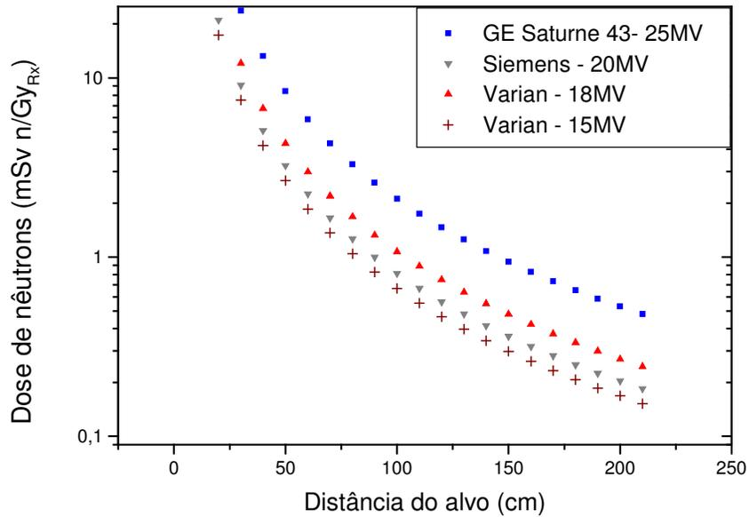
Figura 4.4 – Simulação da variação das taxas de dose com a distância para alguns valores de Q de aceleradores comumente existentes no mercado.
