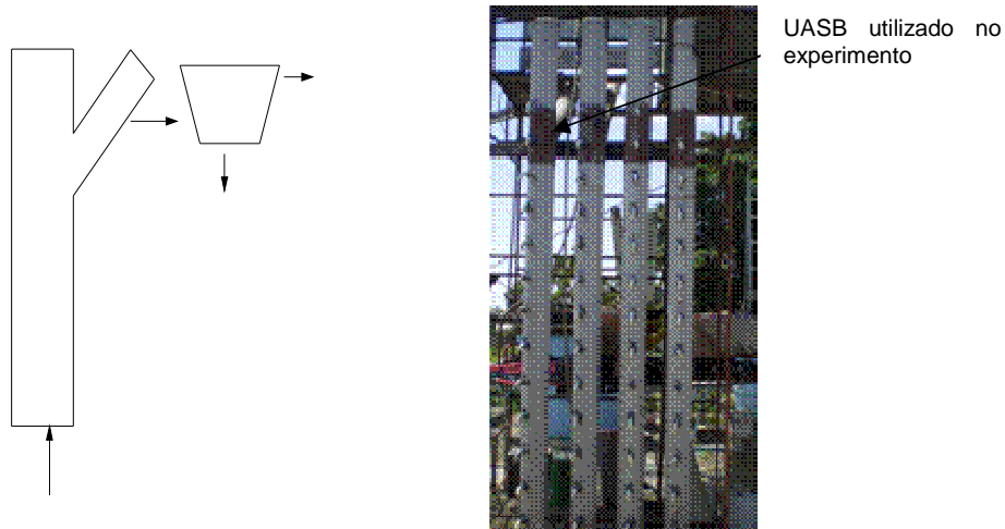
FIGURA 3.3: Esquema da configuração e foto do sistema UASB(EB).
