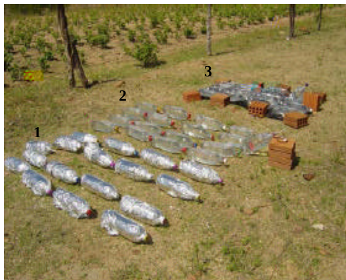
Figura 4.9 – Garrafas expostas ao sol. 1: garrafas controle (embrulhadas em papel alumínio); 2: garrafas transparentes; 3: garrafas transparentes expostas sobre fundo preto. (São José do Sabugí/PB -16/12/05)
