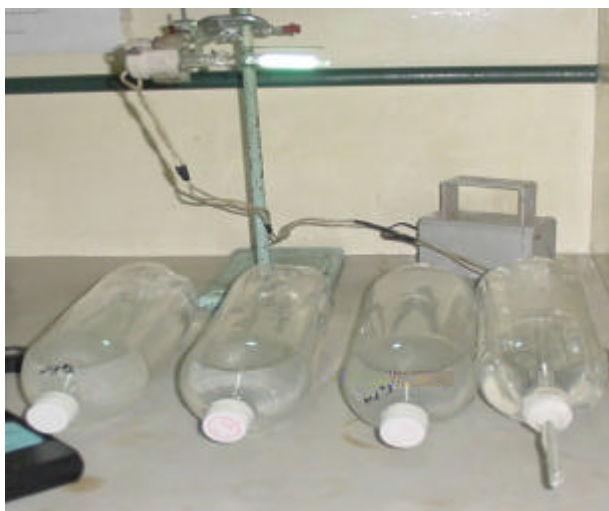
Figura 4.12 – Garrafas expostas à radiação UV de lâmpada germicida 254nm de 125W (Philips) no Laboratório de Química Biológica do Instituto de Química da UNICAMP (Campinas/SP – 20/08/06)
