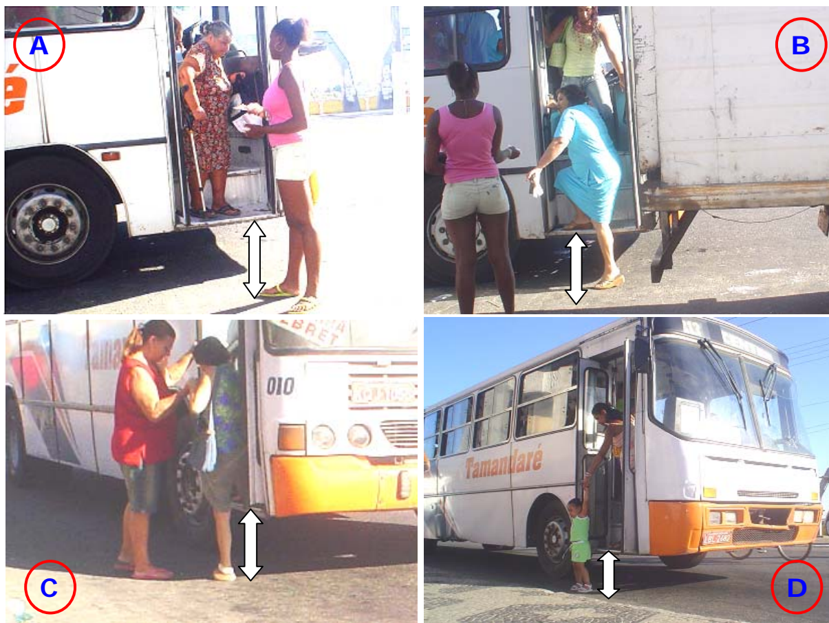
Figura 20 – As fotos: “A”, “B”, “C” e “D” demonstram a dificuldade que os passageiros, especialmente idosos, crianças e deficientes, têm ao desembarcarem dos veículos devido à altura do último piso da escada em relação ao solo, que chegam a atingir 0,50 cm.
