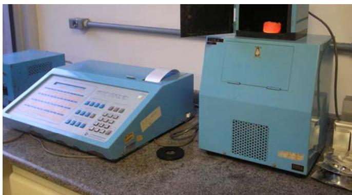
**Figura 11.** Colorímetro fotoelétrico S & M Colour Computer
