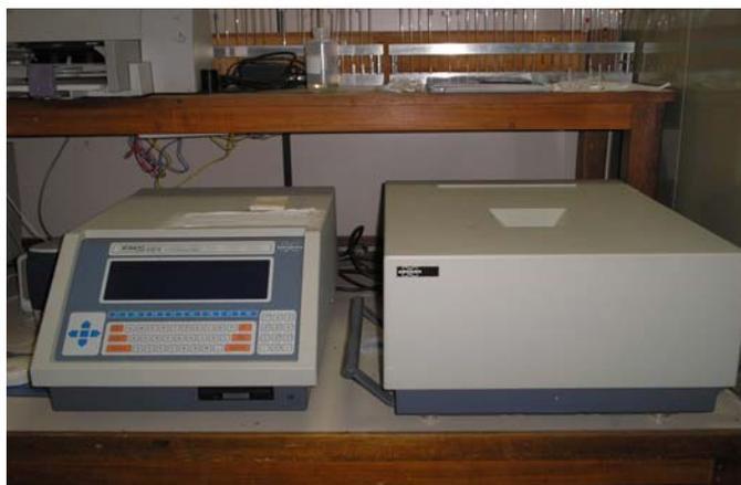
**Figura 14.** Espectrômetro de Ressonância Paramagnética Eletrônica- “RPE”
