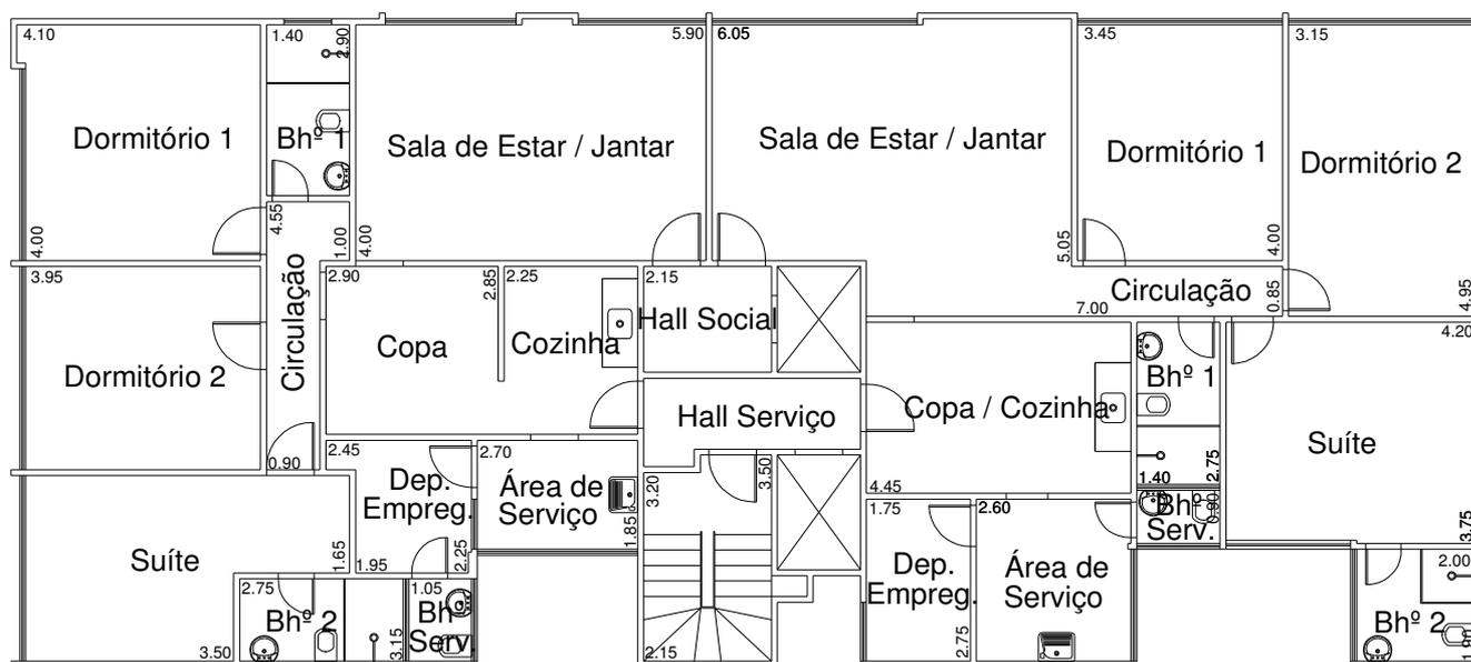
Figura 73: Pavimento Tipo do edifício Visconde do Arari onde aparecem os dois apartamento tipo diferentes entre si, porém com área e programas semelhantes: 115.31 m<sup>2</sup> e 118.97 m<sup>2</sup>.
