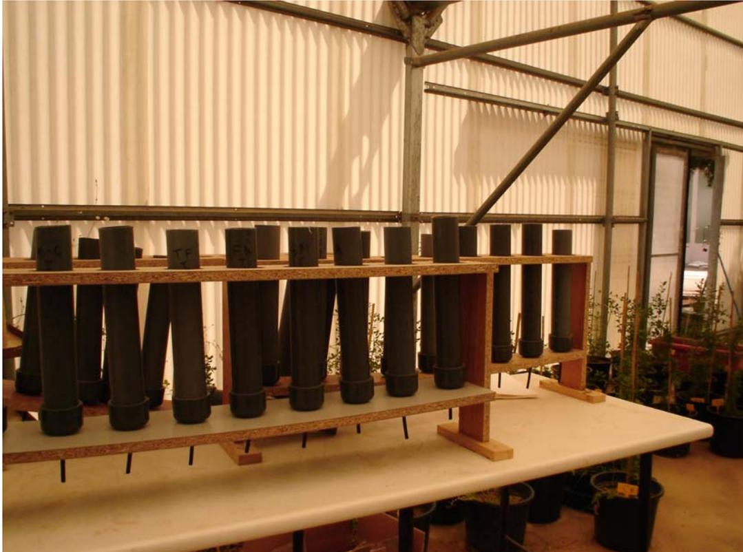
**Figura 37.** Colunas de lixiviação para avaliação das perdas por lixiviação de carbono, nitrato e fósforo de compostos orgânicos obtidos com diferentes materiais e enriquecimentos minerais.
