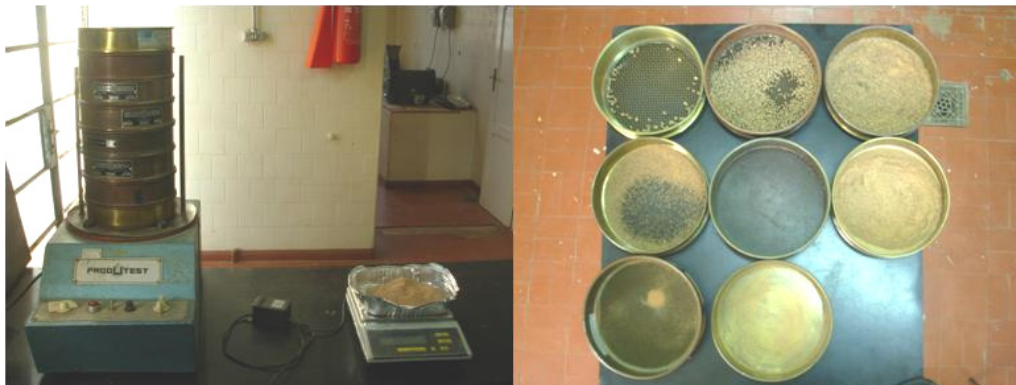
Figura 6 - Agitador automático e jogo de peneiras utilizadas na análise do tamanho médio de partícula
