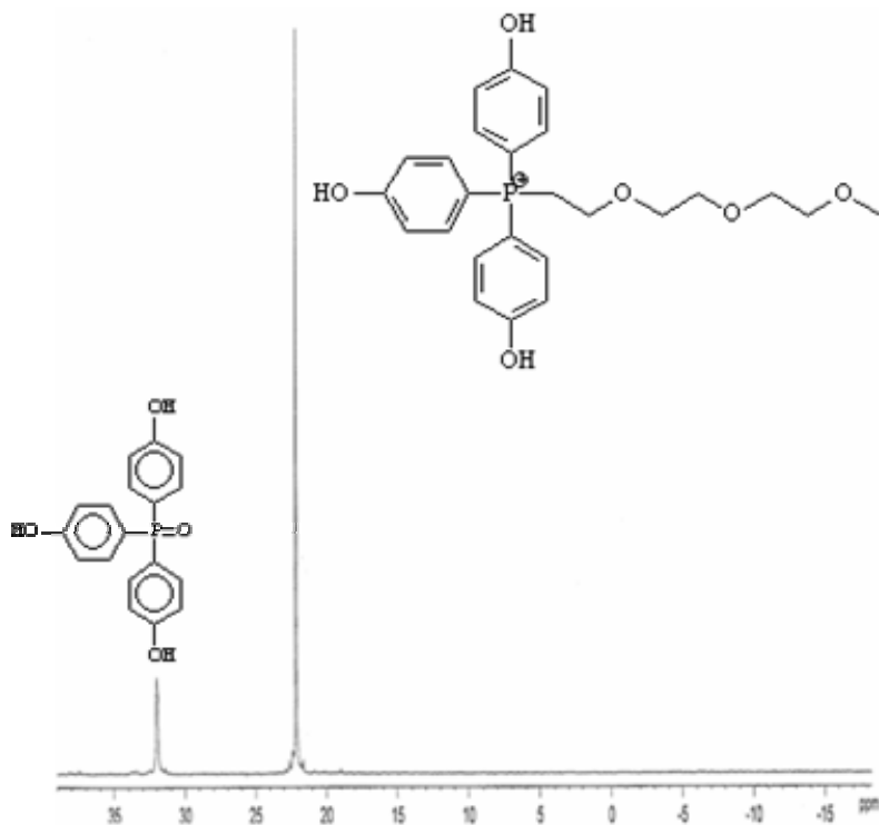
Figura 4.54: Estrutura do composto de fósforo formado após reação com HIDFOF.
