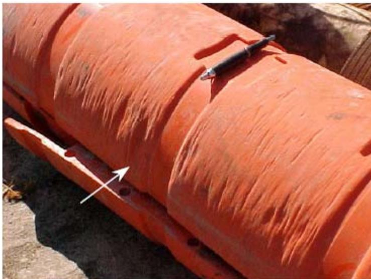
Figura 1.5 – Calha de PU após 44 meses de uso na plataforma P-19, seguimento mais significativamente desgastado na espessura (região indicada pela seta) (FRANCO, 2002)
