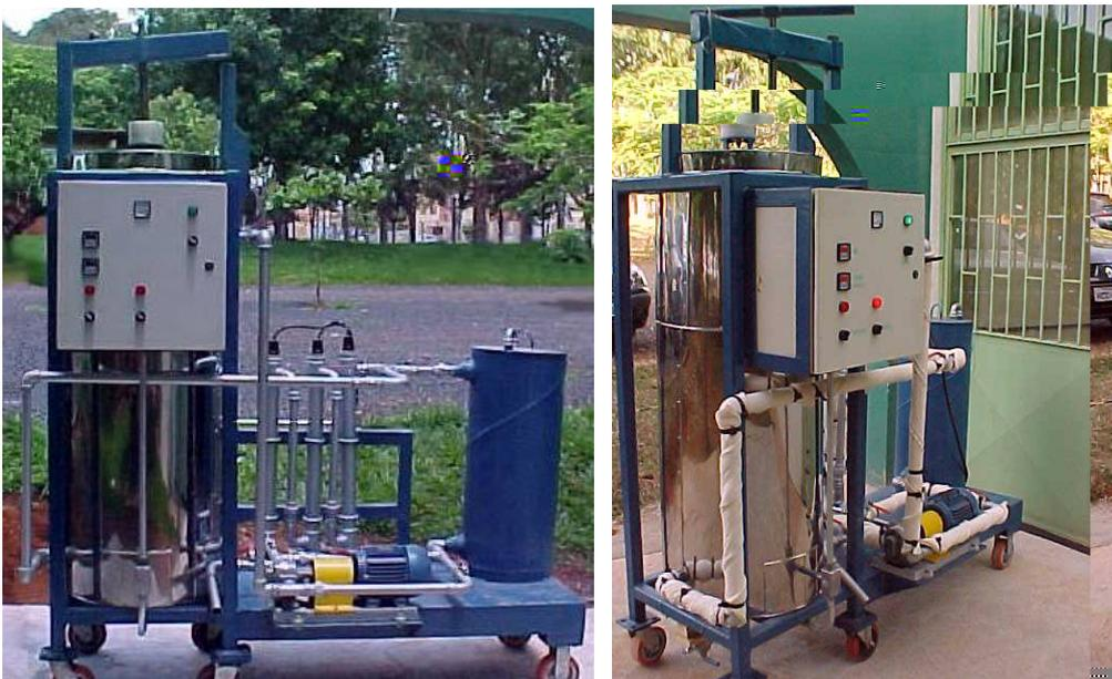
Figura 3.11 – Câmara hiperbárica com sistema de aquecimento.
