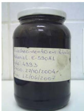
Figura 3.13 – Frasco utilizado para envelhecimento das amostras de poliuretano em petróleo.
