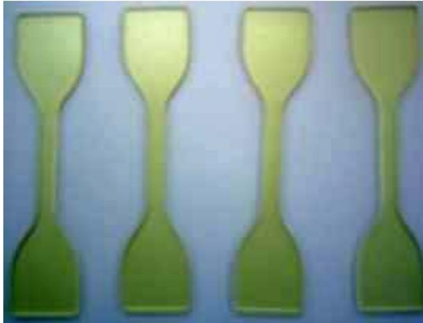
Figura 3.2 – Corpos de prova para ensaio de módulos de tração, tensão e alongamento de ruptura, segundo a norma ASTM D-412.
