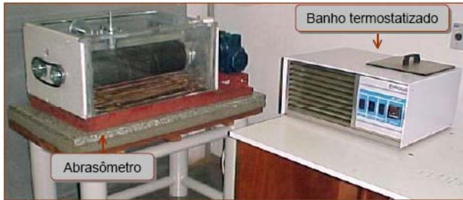
Figura 2.15 – Vista geral do abrasômetro e do sistema de controle de temperatura (RAMOS NETO, 2003).
