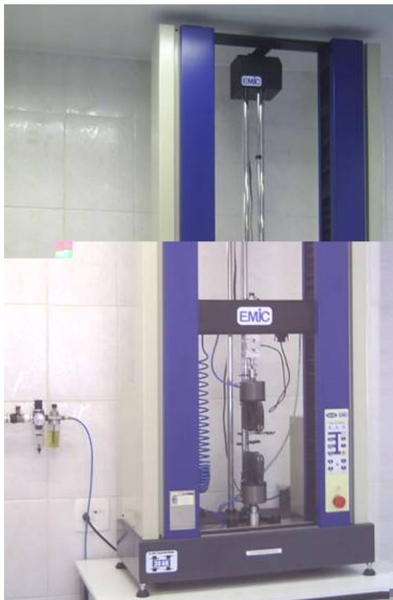
Figura 3.3 – Máquina universal de ensaios.
