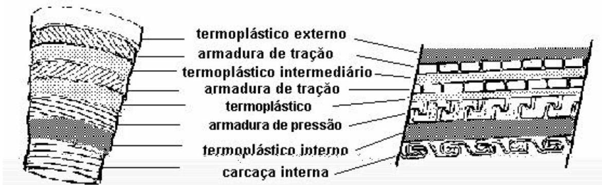
Figura 1.2 – Estrutura típica de um duto flexível (Souza, *et al.*, 2000).
