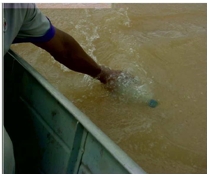
Foto 4.2 – Método de coleta de água utilizando garrafas plásticas previamente lavadas com \text{HNO}_3 0,1N .
