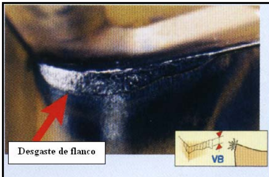
Figura 2.9 – Desgaste de flanco na aresta de corte (Adaptada Sandvik, 2005).
