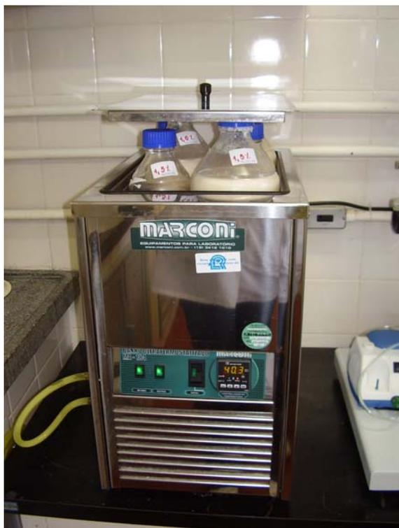
**Figura 5** - Amostras de iogurte no banho termostaticado à 40°C.
