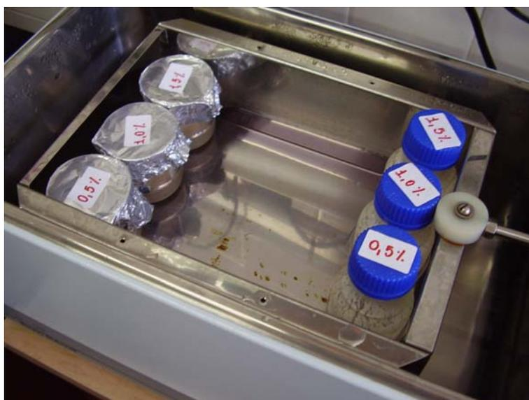
**Figura 6** - Amostras de iogurtes (porções) no banho termostaticado à 40°C, para determinação do valor de pH e acidez durante o processo de fermentação.
