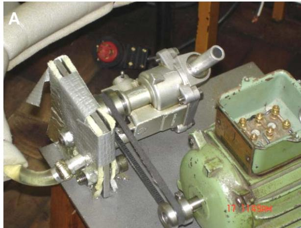
Figura 3.11 – Solução adotada para o sistema de lubrificação.
