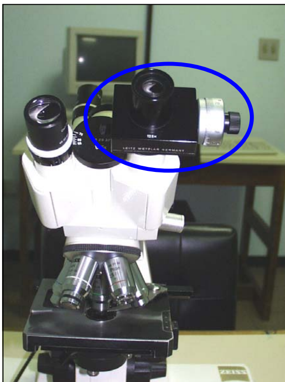
Fig.5: Microscópio óptico de dupla observação com o retículo de medida inserido em uma das oculares (círculo).
