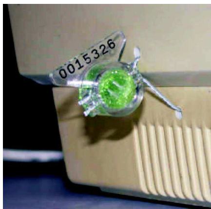
Figura 2.4: Lacre de Emissor de Cupom Fiscal: detalhe do lacre numerado instituído com o objetivo de impedir a abertura de ECF por terceiros não autorizados pela SEF. Fonte: [WAR 03]
