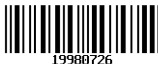
Figura 3.1: Código de barras linear: As informações são representadas por linhas verticais de larguras diferentes, intercaladas por espaços em branco.
