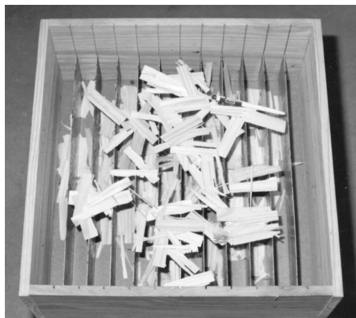
Figura 2. Sistema orientador de partículas e caixa formadora utilizados na formação do colchão (MENDES et al., 2000).
