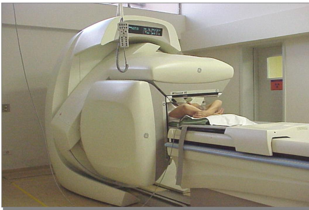
Figura 5 - Visão global da gama-câmara, detalhando-se a paciente posicionada em decúbito supino, detectores de cintilação, console e controles de comando.
