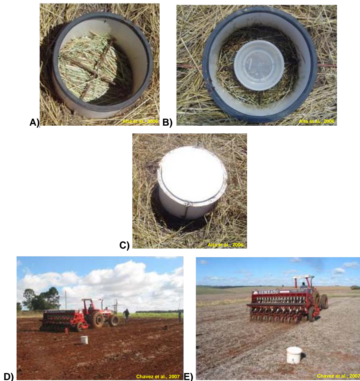
Figura 2 - Câmara estática (câmara de PVC) para medição da evolução de C-CO 2 a campo; a) câmara aberta com armação de ferro; b) câmara com recipiente contendo a solução de NaOH; c) câmara fechada por quatro parafusos; d) câmara instalada em PC; e) câmara instalada em PD.
