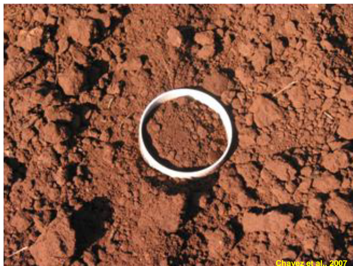
Figura 4 - Colar de PVC do sistema portátil de fotossíntese da câmara dinâmica inserido no solo.
