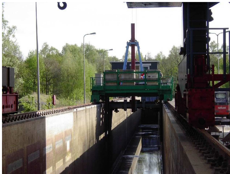
Figura 7.3: Vista do canal, mostrando o carro de reboque e o tubo de vácuo
