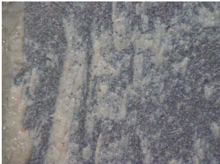
FIGURA 26- Superfície da liga de ouro com remanescente de material cerâmico após o ensaio mecânico (aumento de 50X).
