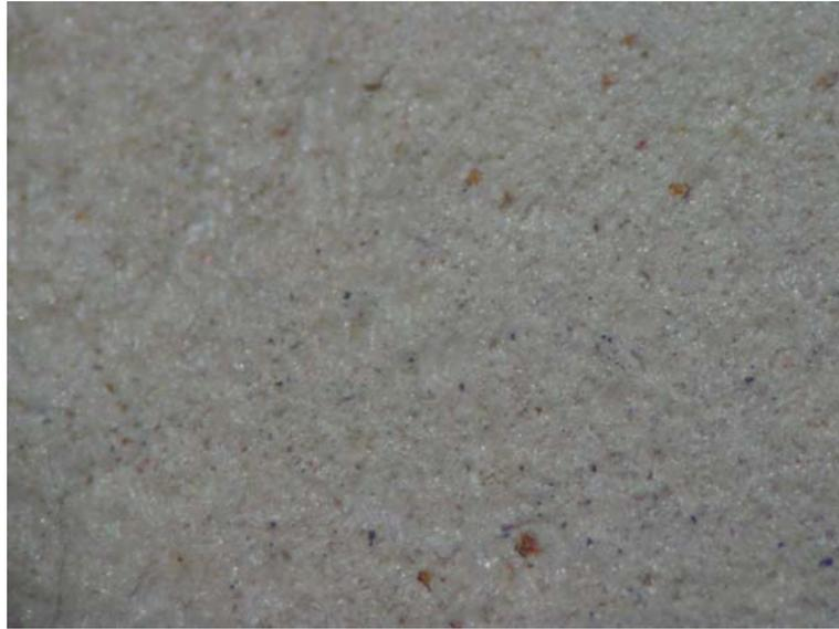
FIGURA 27- Camada cerâmica destacada da superfície da liga áurica.
