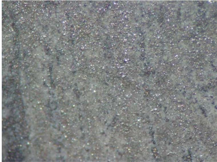
FIGURA 25- Camada do material cerâmico na região da interface com o titânio após o ensaio mecânico (aumento de 50X)
