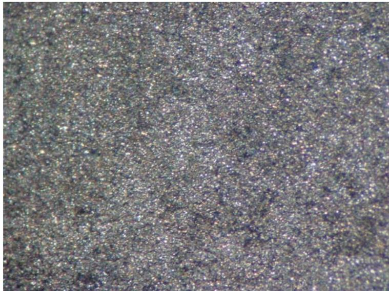
FIGURA 24- Superfície do titânio na região da interface com a cerâmica após o ensaio mecânico (aumento de 50X).
