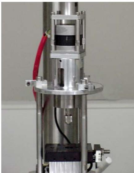
FIGURA 16- Vista aproximada da parte da máquina de ciclagem mecânica responsável pela incidência da força
