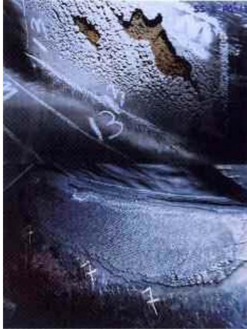
Figura 2.2: Exemplo típico de perfil de turbina hidráulica danificada pelos efeitos do processo de cavitação – (<http://pelton.vatew.com.mx/>)
