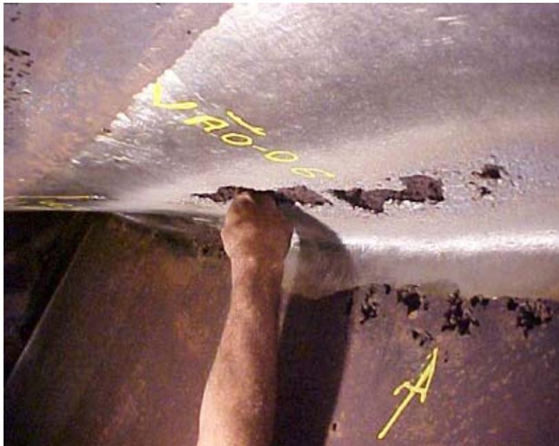
Figura 2.3: Exemplo de cavitação em perfil de rotor de turbina hidráulica. (BARELA, 2005)
