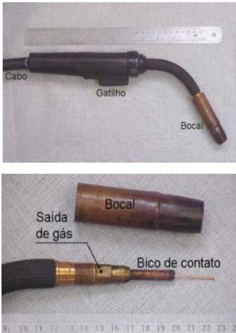
Figura 2.6: Tocha para soldagem GMAW semi-automática. (www.infosolda.com.br)
