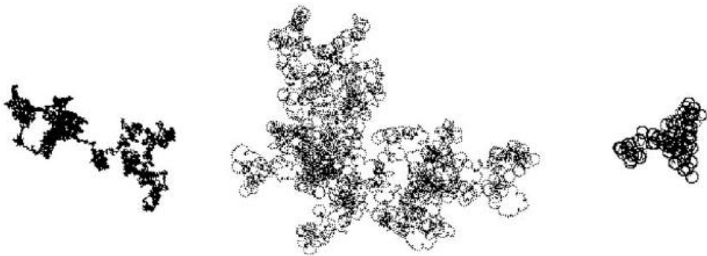
Figura 1.5: Padrões de caminhada gerados com 10^4 passos de tempo, r_g = 5 e \theta = 0.4rad . Da esquerda para a direita temos P_g = 0.0, 0.8 e 0.99 .
