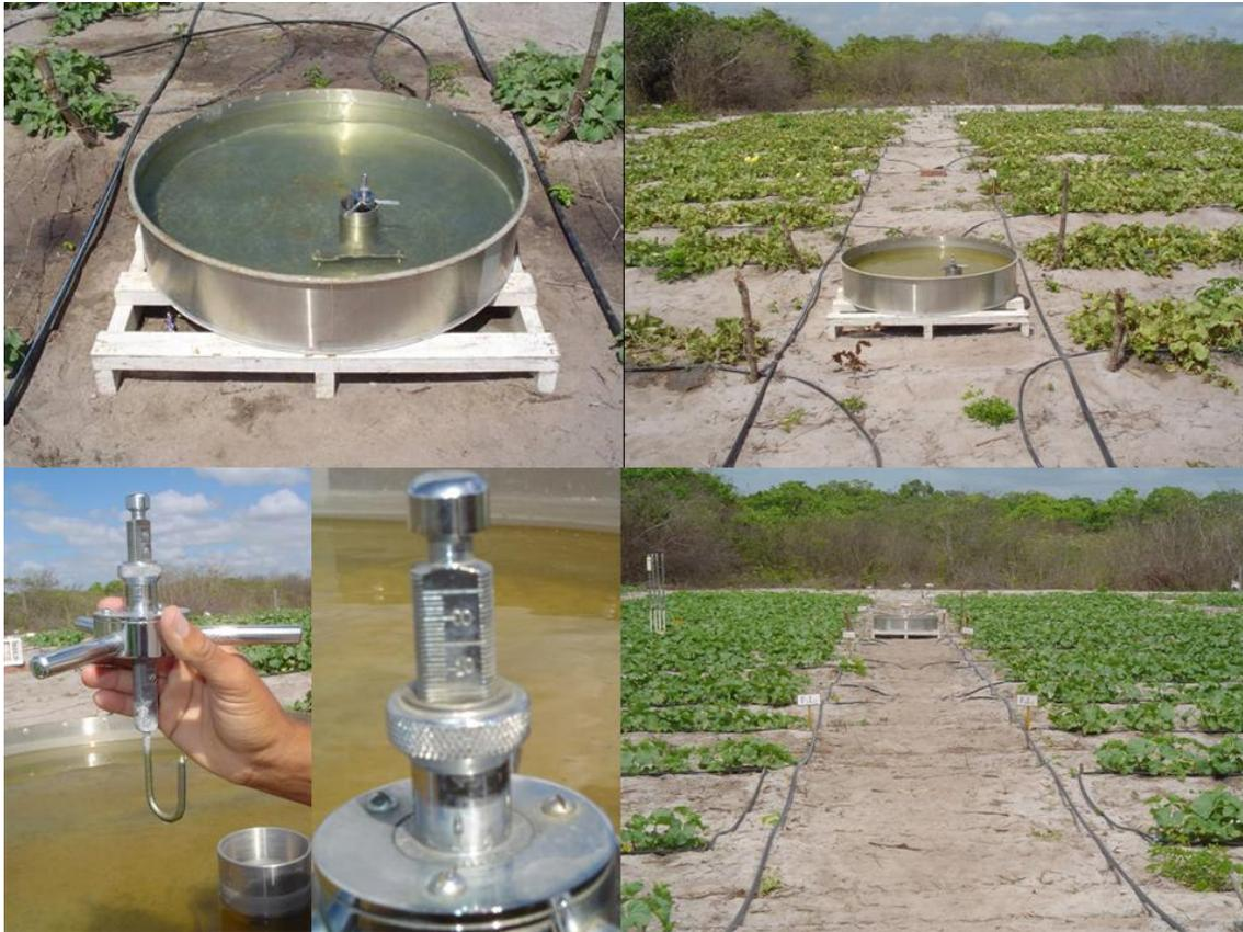
Figura 8. Demonstração do tanque evaporímetro Classe “A”.
