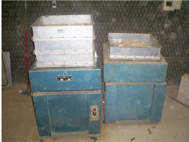
Figura 4.12: Mesas vibratórias utilizadas para peneiramento de amostras de AGRECV-ES
