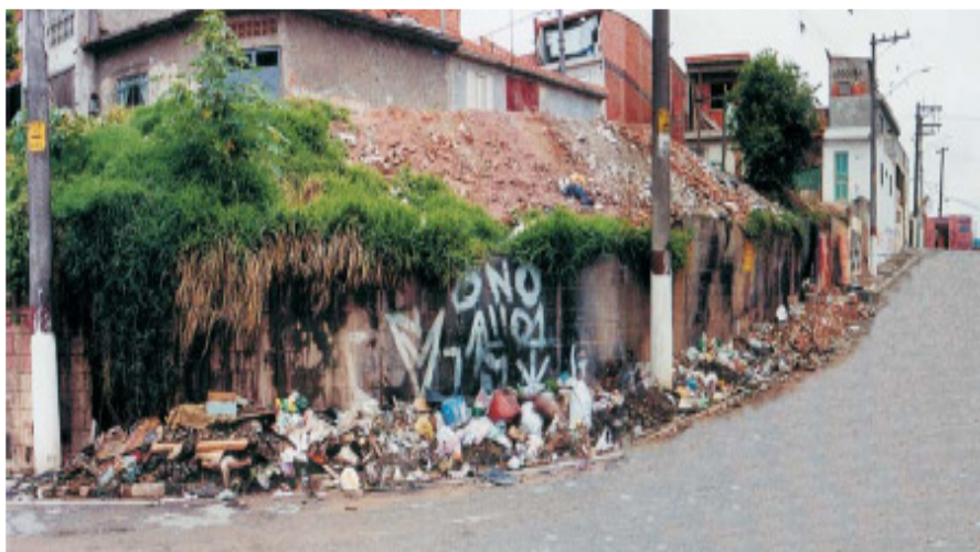
Figura 3.7: Disposição irregular de RCC's em encosta em Diadema - SP Fonte: Pinto & Gonzáles (2005)
