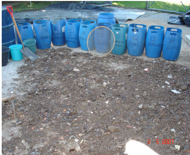
Figura 4.8: Espalhamento de amostra de ENTUV-ES para a realização de atividades visando à obtenção de composição gravimétrica
