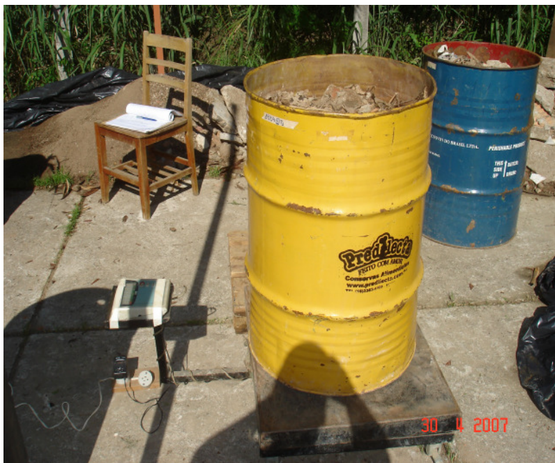
Figura 4.7: Pesagem das amostras compostas de ENTUV-ES
