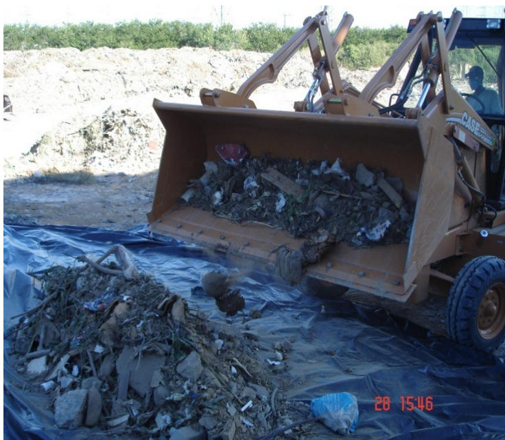
Figura 4.6: Formação de pilha de ENTUV-ES sobre lona plástica após o quarto quarteamento
