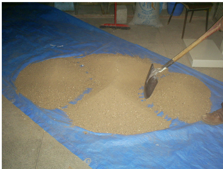
Figura 4.14: Quarteamento manual realizado com pá
