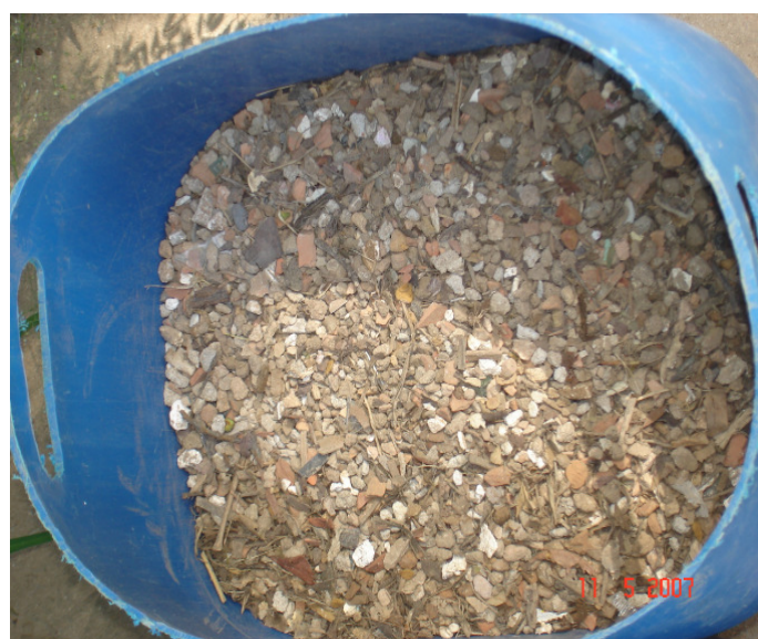
Figura 4.10: Grupo “9.outros” - material pertencente à Classe A, passante na peneira 12,5mm e retido na peneira 4,75mm
