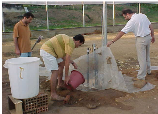
TDR's utilizados nos ensaios de calibração – detalhes da trincheira e das leituras do conteúdo de água do solo
