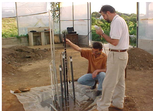
TDR's utilizados nos ensaios de calibração – detalhes da trincheira e das leituras do conteúdo de água do solo
