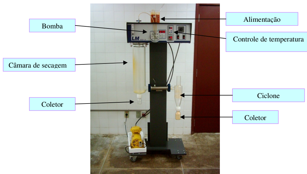
Figura 3.3 – Secador por aspersão (spray dryer)
